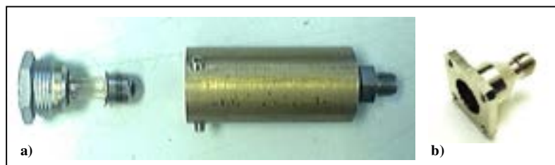
Figura 6 - a) accoppiatore custom in ottone (con connettore Lemo 2C) ; b) accoppiatore Amphenol 905-117-5000
