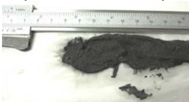
Figura 4 Slurry di carbone, grana da 0.1 mm, umido.
