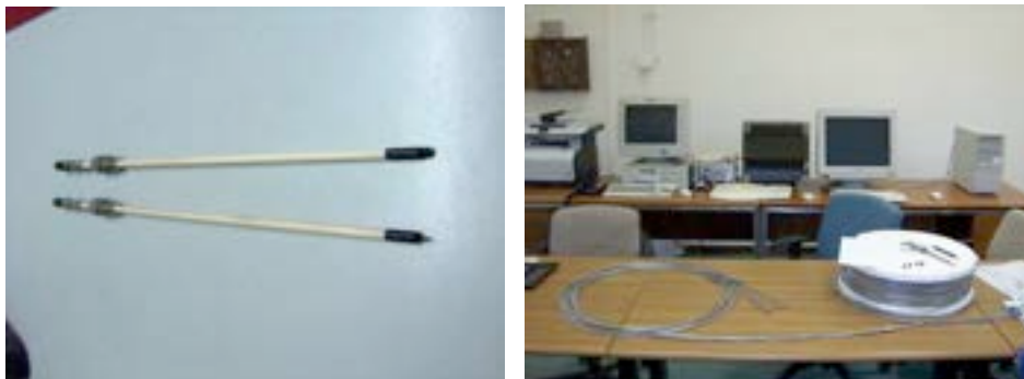
Figura 1 Sonde per alta temperatura, in zaffiro. Fibra ottica in quarzo (45 mt) per remotizzare il segnale ottico delle sonde
