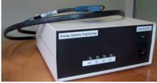
Figura 2 Box di interfaccia per la trasduzione ottica-elettrica
