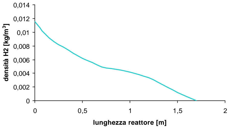
Fig. 48 – Profilo di concentrazione dell'H 2 lungo il reattore
