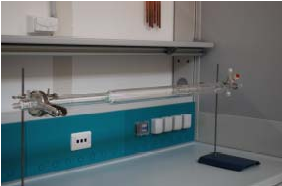
Fig. 1.14: Reattore di desolfurazione
