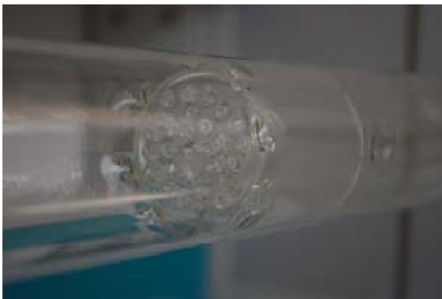
Fig. 1.15: Reattore di desolforazione: particolare della griglia fissa per il contenimento del letto fisso
