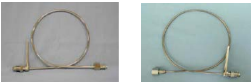
Fig. 1.7: Serpentine di collegamento per la bombola contenente H_2S/N_2 (foto a sinistra) e per la bombola contenente N_2 (a destra)
