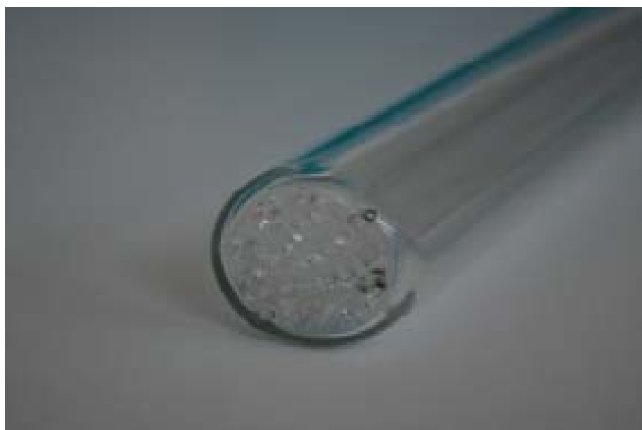
Fig. 1.16: Reattore di desolforazione: particolare della griglia mobile per il contenimento del letto fisso
