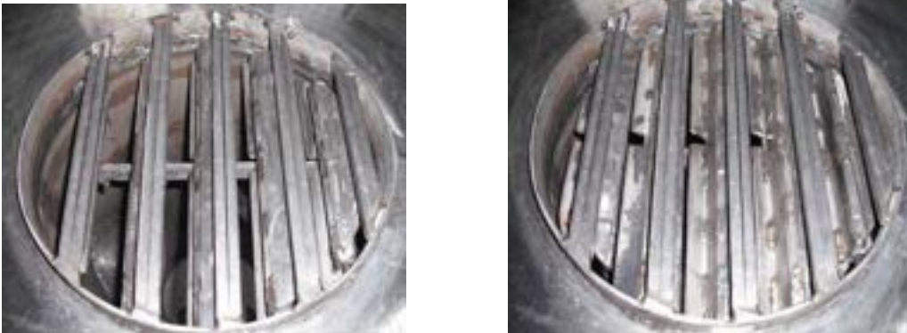
Fig. 18: Vista di dettaglio della griglia in posizione aperta e chiusa.
