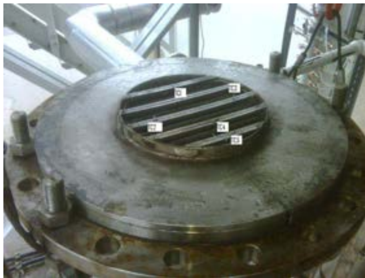
Fig. 23: Posizionamento delle cinque termocoppie alloggiare sulla griglia
