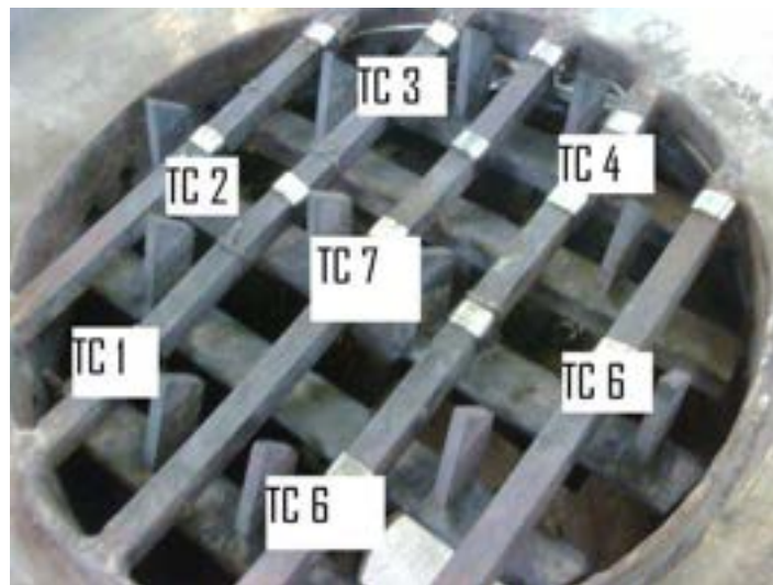
Fig. 25: Posizionamento delle sette termocoppie alloggiate sulla griglia
