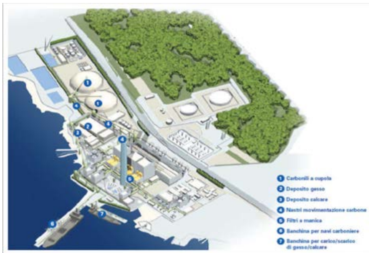
Figura 3.13 - Impianto Torre Valdaliga (Civitavecchia) Fonte [15]
