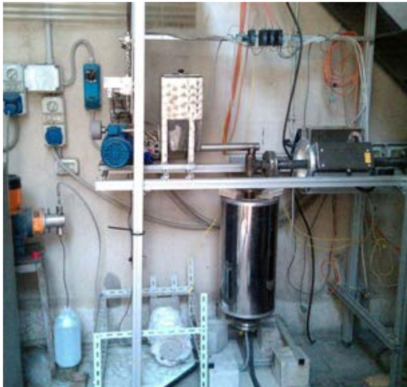
Figura 15: Impianto di gassificazione presso il Dip. di Ingegneria Chimica
