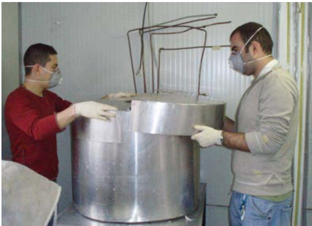
Figura 6 - Sistema MCFC di FN durante la fase finale dell'assemblaggio.
