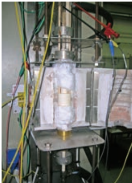
Fig. 7 – Impianto per la caratterizzazione di elettrodi con area 3 cm 2 .
