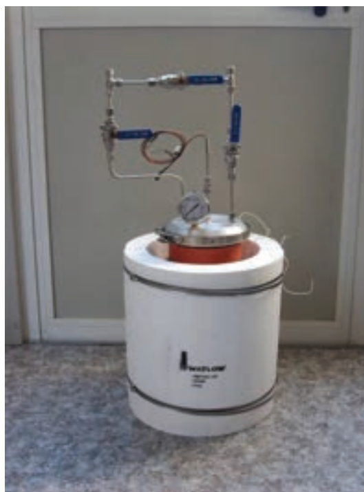
Fig. 33 – Gorgogliatore: sistema di isolamento termico
