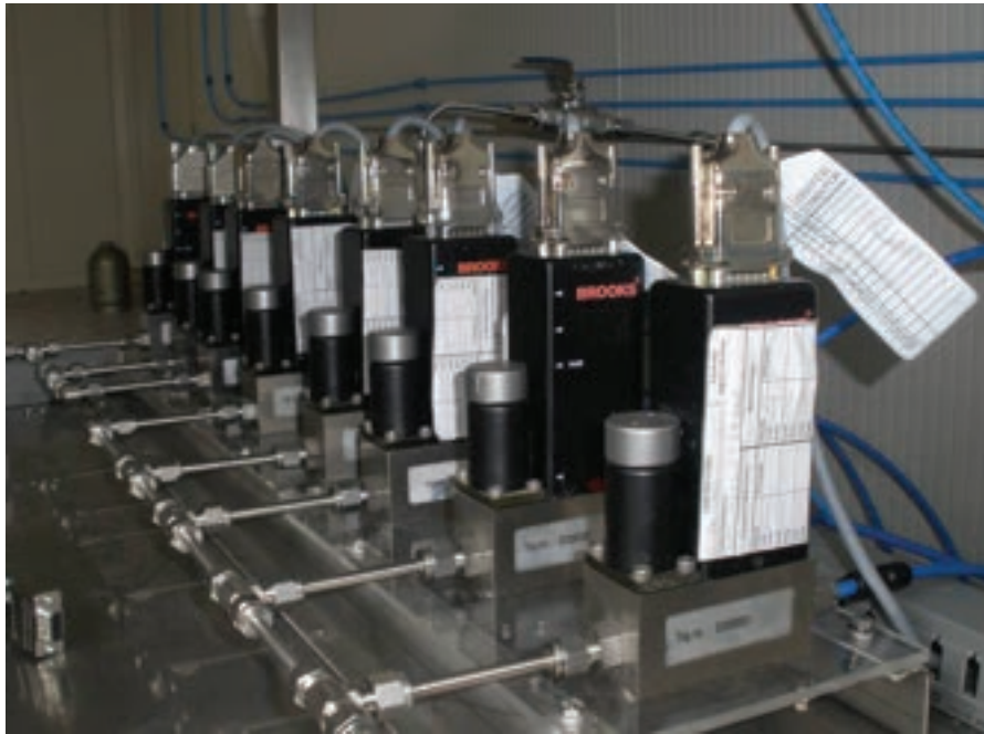
Figura 29 – Posizionamento dei flow-meters nel banco prova
