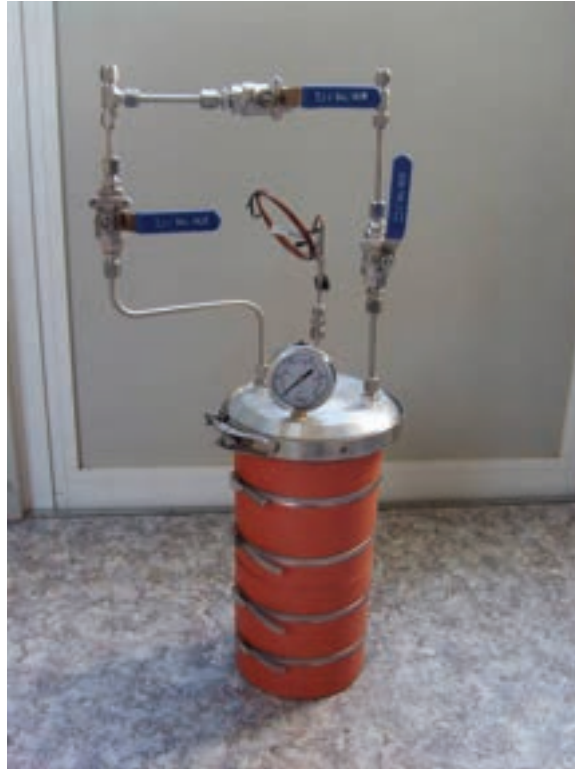
Figura 31 – Gorgogliatore: circuito di by-pass e di drain
