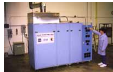
Sistema SOFC da 25 kW (Ztek)
