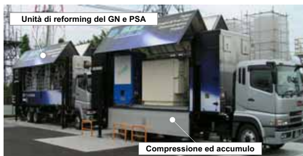
Stazione idrogeno Ome (Tokyo) - Progetto JHFC
