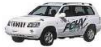
Marzo 2001 - Toyota FCEV-3 Potenza: 90kW (stack Toyota) / batteria Autonomia: 250 km Velocità max: 150 km/h Combustibile: idrogeno in idruri metallici
