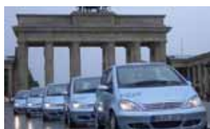
F-Cell, 2004 Potenza: 72 kW Autonomia: 177 km Velocità max.: 140 km/h Combustibile: idrogeno (350 bar) Batteria: NiMH
