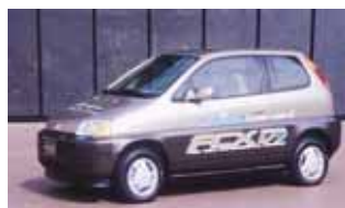
1999 - Honda FCX-V1 Potenza: 62 kW (stack Ballard Mark 700) Autonomia: 170 km Velocità max: 130 km/h Combustibile: idrogeno in idruri metallici
