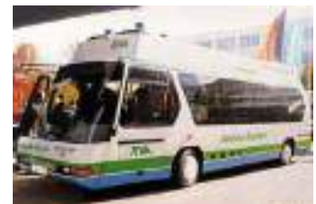
Neoplan - Autobus di Oberstdorf Potenza: 55 kW PEFC (Nuvera) 21 kW batteria Autonomia: 600 km Velocità max: 50 km/h
