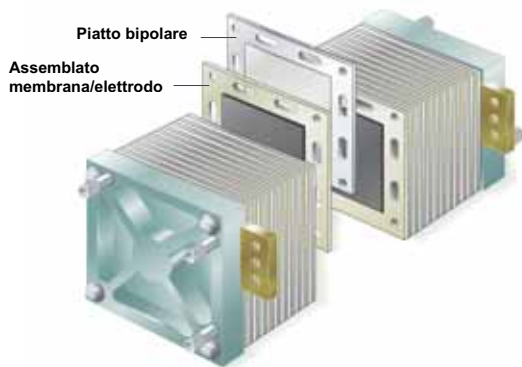
Stack di celle ad elettrolita polimerico (Fonte: PEMEAS/BAFS Fuel Cells)
