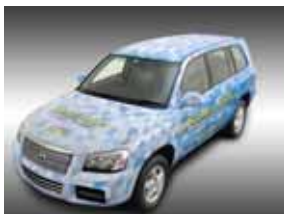
Ottobre 2007 - Toyota FCHV Potenza: 90kW (stack Toyota) / batteria NiMH Autonomia: 560 km (in condizioni reali) Combustibile: idrogeno (700 bar)
