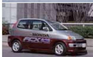
2001 - Honda FCX-V4 Potenza: 75 kW (stack Ballard Mark 900) Autonomia: 300 km Velocità max: 140 km/h Combustibile: idrogeno (350 bar)
