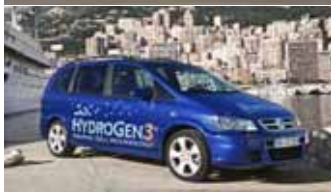
2001- HydroGen 3 Potenza: 94 kW Velocità max: 160 km/h Autonomia: 400 km/h Combustibile: idrogeno liquido
