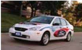
2002- Focus FCEV Hybrid Potenza: 68 kW (85 kW Ballard Mark902) batteria NiMH (Sanyo 216 V) Autonomia: 260-320 km Velocità max: 128 km/h Combustibile: idrogeno (350 bar)
