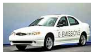
1999 - Ford P2000 (concept car) Potenza: 60 kW (3 stack Mark700) Autonomia: 160 km Combustibile: Idrogeno
