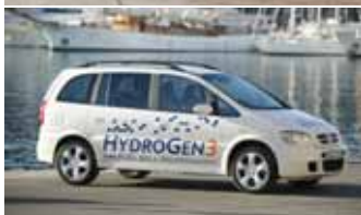
2002- HydroGen3 Potenza: 94 kW Velocità max: 160 km/h Autonomia: 270 km/h Combustibile: idrogeno (700 bar)
