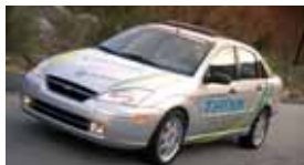
2000 - Focus FC5 Potenza: 75 kW (Ballard Mark900) Autonomia: Velocità max: 128 km/h Combustibile: metanolo
