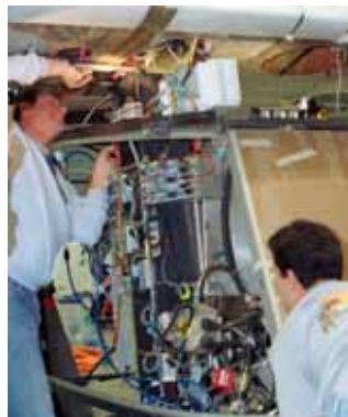
Montaggio della PEFC AeroVironment sul prototipo Helios (NASA)
