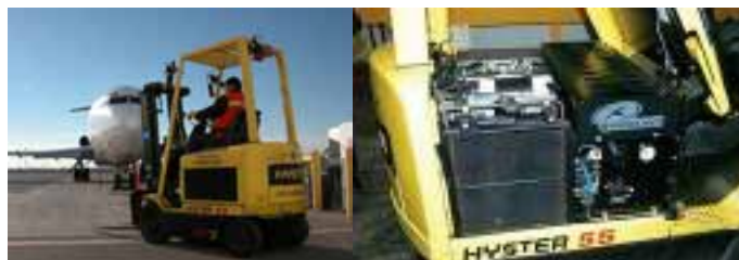
Carrello elevatore Hyster alimentato con un unità HyPM da 12 kW
