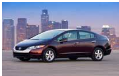
2007 - Honda FCX Clarity Potenza: 100 kW (stack Honda) Batteria Li-ione Autonomia: 430 km Velocità max: 160 km/h Combustibile: idrogeno (350 bar)
