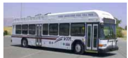
2004 - Autobus Gillig alla Santa Clara VTA Potenza: 205 kW (stack Ballard) Combustibile: idrogeno (350 bar, 55 kg)
