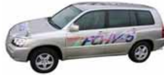
Ottobre 2001 - Toyota FCEV-5 Potenza: 90 kW (stack Toyota) / batteria Combustibile: benzina a basso contenuto di zolfo
