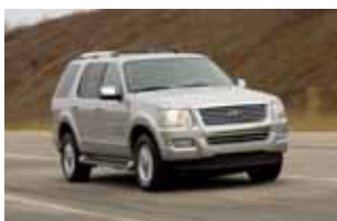
2006 - Ford Explorer Potenza: 60kW (stack Ballard) 50 kW Batteria NiMH Autonomia: 560 km Combustibile: idrogeno (700 bar)
