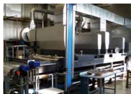
Impianto di tape casting presso FN, (particolare del banco di rullatura)
