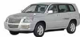
Dicembre 2002 - Toyota FCHV Potenza: 90kW (stack Toyota) / batteria Autonomia: 290 km Velocità max: 155 km/h Combustibile: idrogeno (350 bar)
