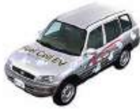
Ottobre 1996-Toyota RAV4 FCEV Potenza: 20 kW (stack Toyota) / batteria Autonomia: 250 km Velocità max: 100 km/h Combustibile: idrogeno in idruri metallici
