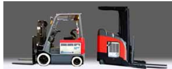
General Hydrogen - Veicoli industriali alimentati con moduli Hydricity Pack da 12,5 kW e 9 kW (unità Ballard)
