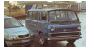
1967 - "Electrovan" GM Potenza celle: 5 kW (stack AFC) Autonomia: 200 km Velocità max: 105 km/h Combustibile: idrogeno liquido
