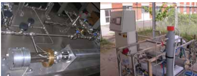
Prototipo di serbatoio ad idruri metallici e relativa stazione di prova (ENEA)
