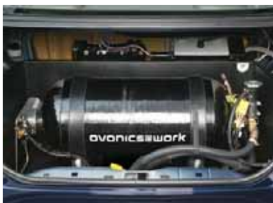
2006 - Serbatoio Ovonics (1500 psi, idruri metallici) Capacità: 3 kg H 2 Densità gravimetrica: 1,58 %p H 2 Volume: 50 L Peso: 190 kg
