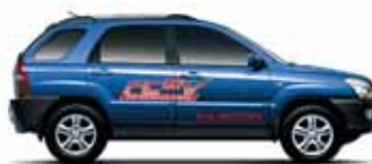
2004 - Kia Sportage Potenza: 80 kW (stack UTC Power) Autonomia: 300 km Velocità max: 150 km/h Combustibile: idrogeno (350 bar)
