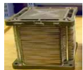
Stack SOFC VPS Potenza : 1,152 kW (28 celle, area attiva 121 cm 2 )
