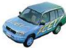
Settembre 1997-Toyota RAV4 FCEV Potenza: 25 kW (stack Toyota) / batteria Autonomia: 500 km Velocità max: 125 km/h Combustibile: metanolo
