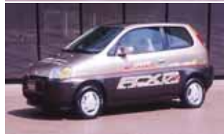
1999 - Honda FCX-V2 Potenza: 60 kW (stack Honda) Autonomia: 130 km Combustibile: Metanolo
