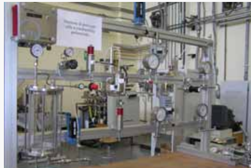
Stazione di prova per celle da 500 cm 2 (ENEA, Laboratori C.R. Casaccia)
