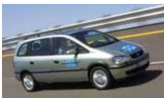
2000 - HydroGen1 Potenza celle: 80 kW Autonomia: 400 km Velocità max: 140 km/h Combustibile: idrogeno liquido
