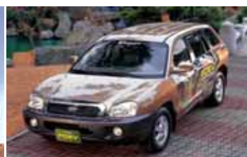
2001 - Hyundai Santa Fe FCEV Potenza: 75 kW (stack UTC Power) Autonomia: 400 km Combustibile: idrogeno (350 bar)
