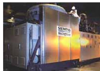
Sistema ibrido SOFC/MTG da 220 kW, University of California, Irvine (USA)
