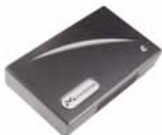
Mobion (prototipo proof-of-concept) Potenza: 1 W Dimensioni: 9,4 x15,2 x3,3 cm
