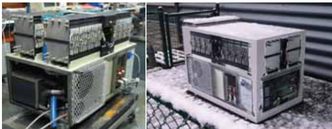
Sistema CHP 6 kW (4 stack AFC) - VITO / Intensys
