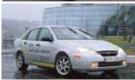
2001- Focus FCV Potenza: 75 kW (Ballard Mark900) Autonomia: 160 km Velocità max: 128 km/h Combustibile: idrogeno (350 bar)
