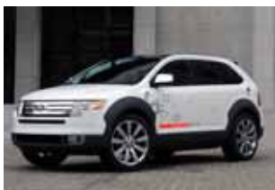
2007 - Ford Edge Ibrido batterie Li-ione/PEFC Autonomia: 360 km Velocità max: ~140 km/h Combustibile: idrogeno (350 bar)
