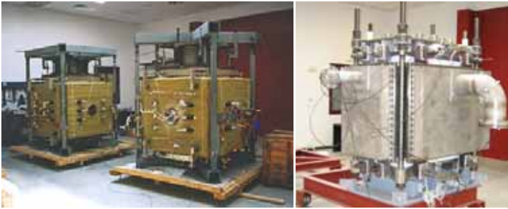
Stack dell'impianto proof of concept da 100 kW (Ansaldo Fuel Cells)
