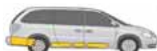
Potenza: celle 50 kW /batteria Autonomia: 500 km Velocità max: 129 km/h Combustibile: idrogeno da NaBH 4
