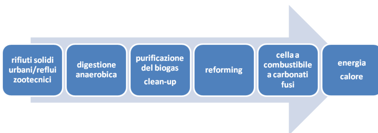
Fig. 1 – Schema di utilizzo di scarti urbani o agricoli per l'alimentazione con biogas di uno stack di celle a combustibile ad alta temperatura.
