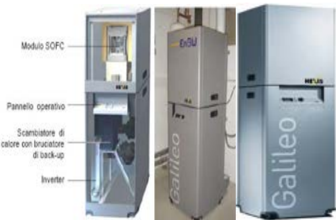
Figura 29. Hexis Galileo 1000N. Misure 55 x 55 x 160 cm3, peso 170
