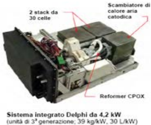
Figura 12. Sistema integrato Delphi da 4.2 kW. Unità di 3a generazione; 39 kg/kW, 30 l/kW.
