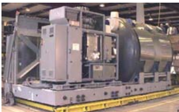
Figura 10. Sistema SOFC-mGT da 300 kW (PH300).
