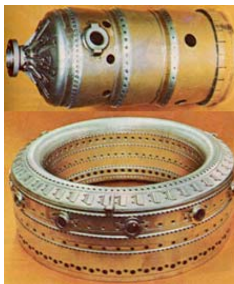
Figura 42. Camere di combustione tubolare (in alto) e anulare (in basso) (G. Cornetti, Macchine Termiche, Il Capitello).
