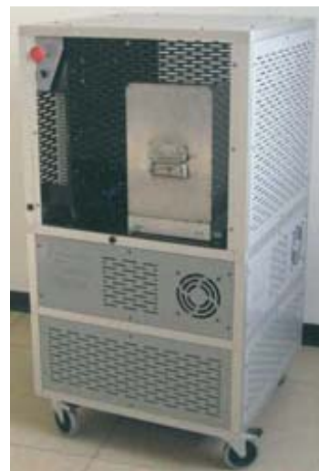
Figura 32. Sistema HotBox. Peso 17,5 kg dimensioni 220x220x320 mm, temperatura operativa 750°C temperatura dei gas esausti 200 - 500 °C.
