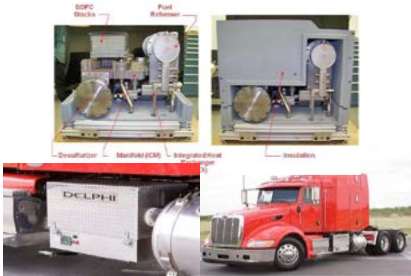
Figura 11. Soluzione APU SOFC di Delphi, in collaborazione con Volvo Trucks North America.
