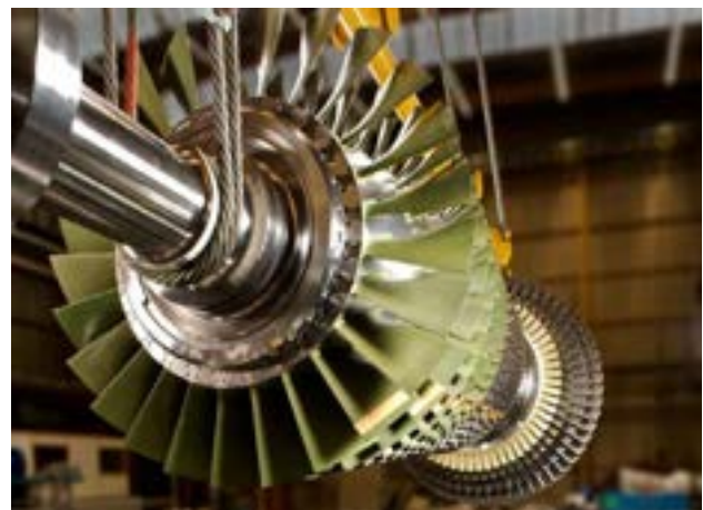
Figura 43. Particolare di un gruppo turbogas monoasse Alstom GT11N2, nella fase di assemblaggio: è possibile distinguere il compressore e la turbina assiali pluristadio ( www.power.alstom.com )
