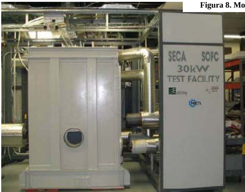
Figura 9. Sistema FCE-VPS SOFC da 30 kWe.
