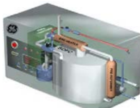
Figura 16. Modello del sistema GE-HPGS (Hvbrid Power Generation System).
