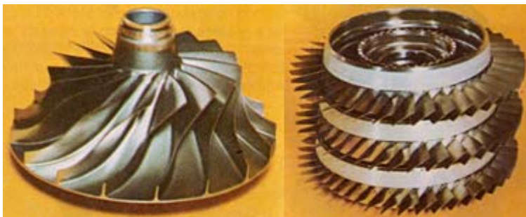
Figura 40. (a destra) Stadio di un rotore di un compressore centrifugo; (a sinistra) rotore di un compressore assiale tri-stadio (G. Cornetti, Macchine Termiche, Il Capitello).
