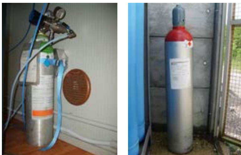
Figura 29. Bombola di H 2 S in azoto ancorato alla rastrelliera (sinistra) e in idrogeno (destra).
