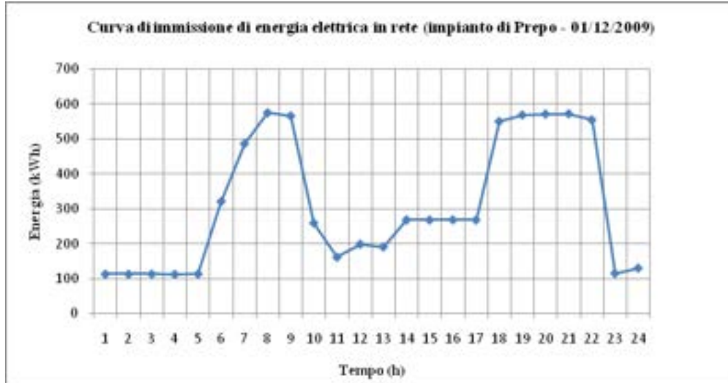
Fig. 7 - Curva di immissione di energia elettrica in rete del 1 dicembre 2009 (impianto di Prepo).
