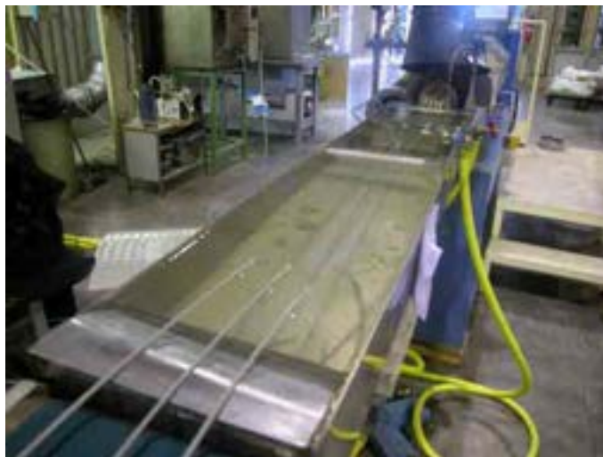
Fig. 68 – Estrusione di spaghetti a base Nichel
