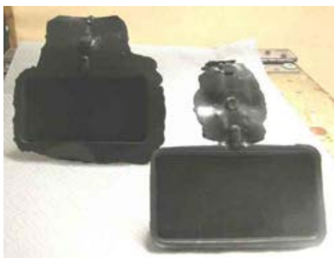
Fig. 87 - Confronto fra semilavorati di anodo (a sinistra) e di catodo (a destra)
