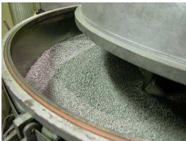
Fig. 14 – Essiccatore a sinistra, a destra particolare dell'interno con il compound ad essiccare
