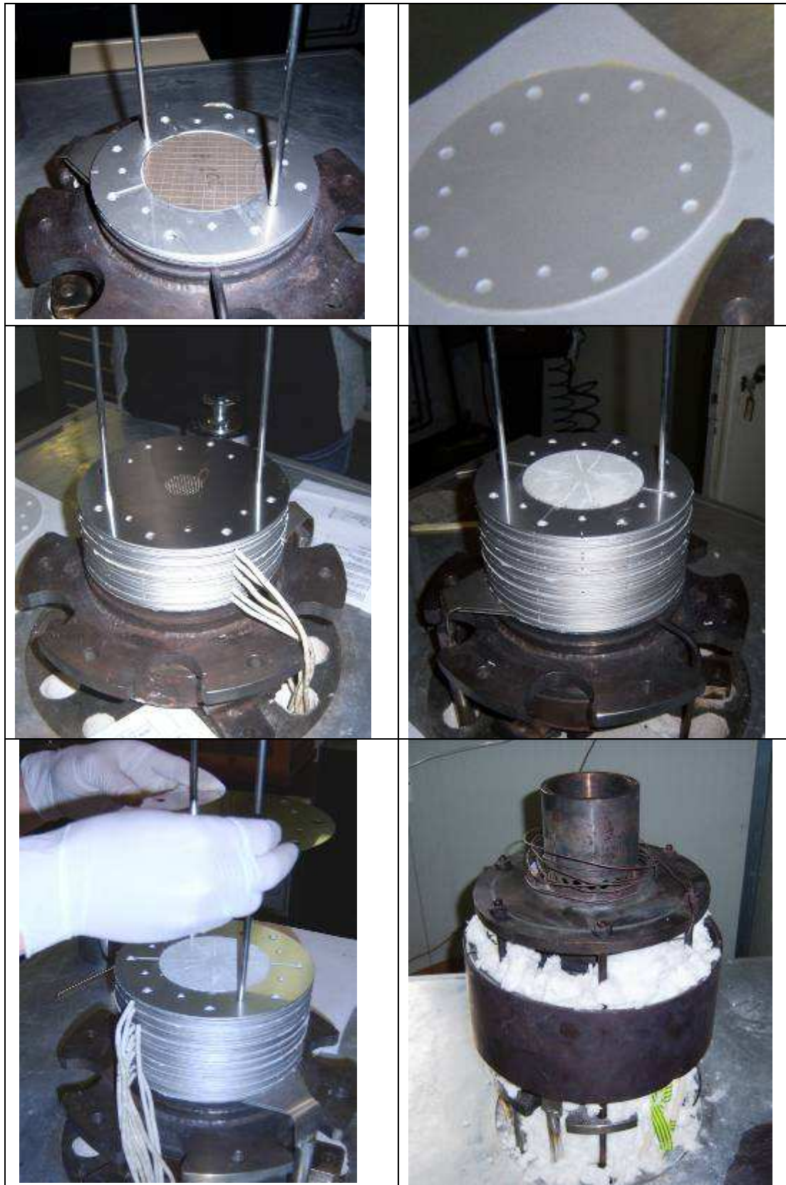
Fig. 29 - Stack in fase di montaggio
