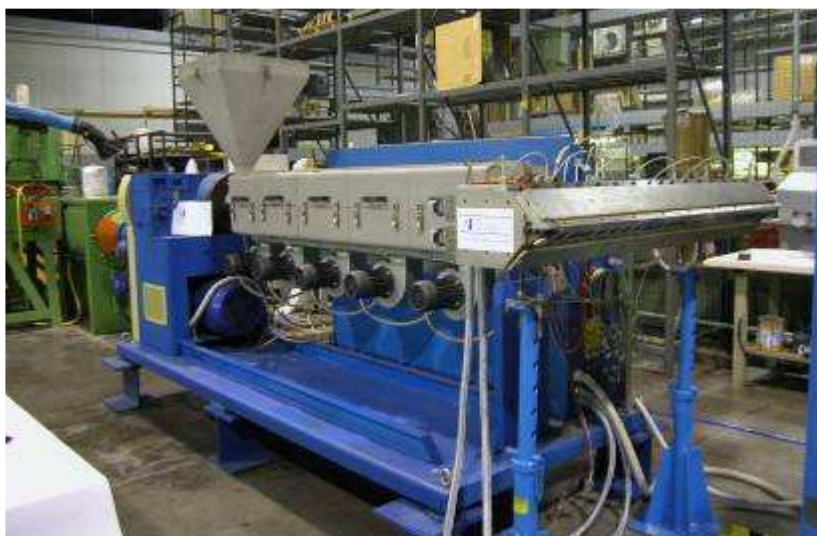
Fig. 15 – Estrusore Toscana corredato del sistema di gestione elettronica
