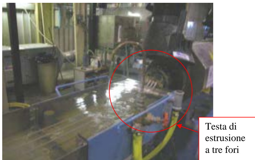
Fig. 11 – Particolare della testa di estrusione a tre fori
