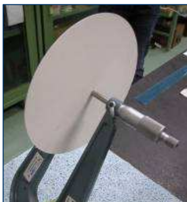
Fig. 1 – Controllo dello spessore
