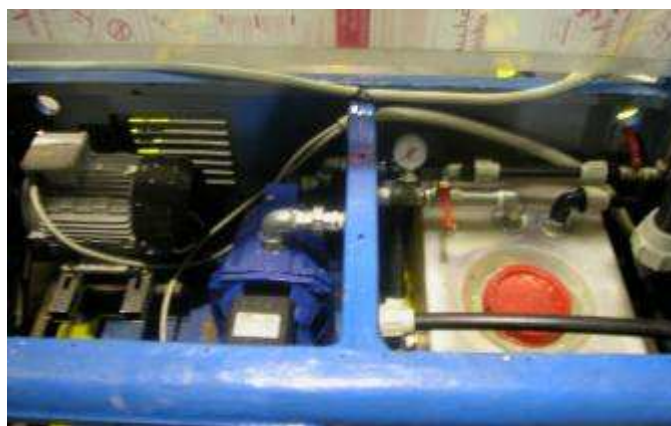
Fig. 17 – Particolari dell'impianto idraulico di raffreddamento della calandra
