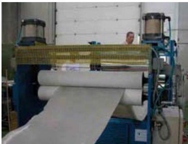
Fig. 26 – Uscita del materiale dal traino
