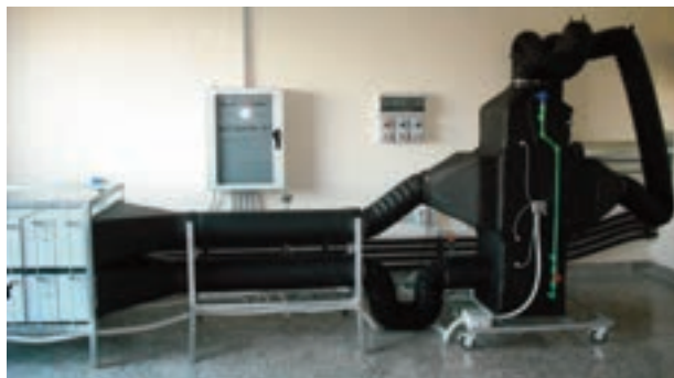
Set up sperimentale per il test di componenti aeraulici
