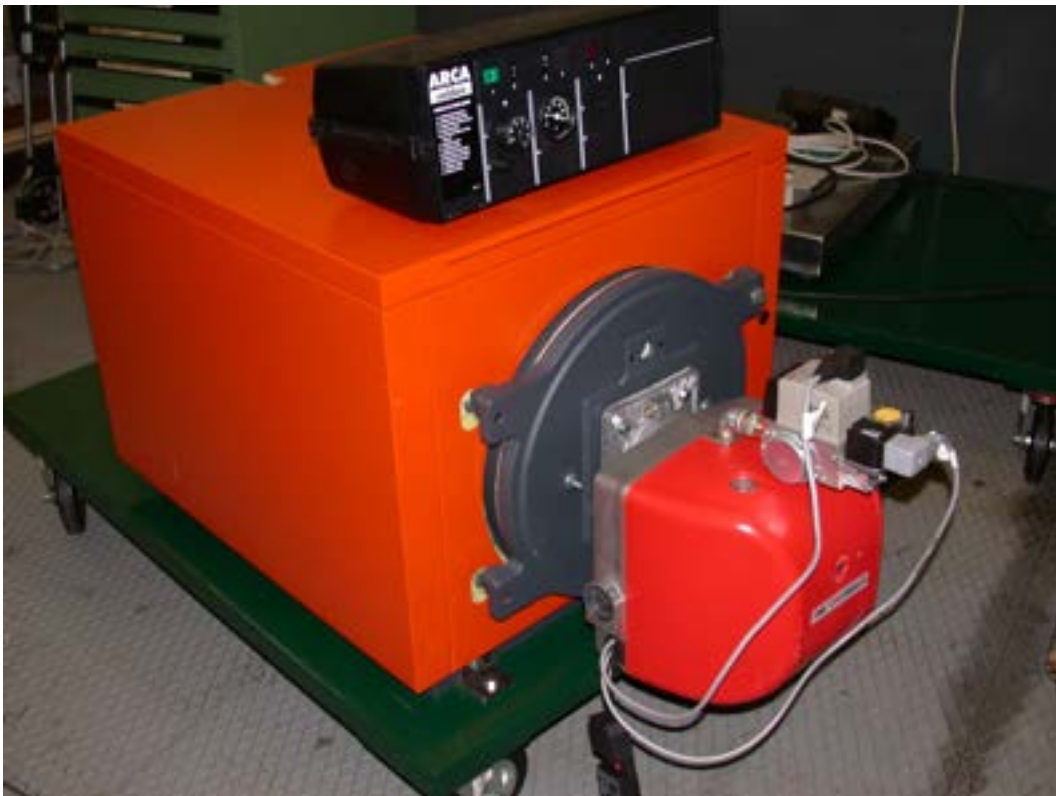
Fig. 13: Caldaia di alimentazione
