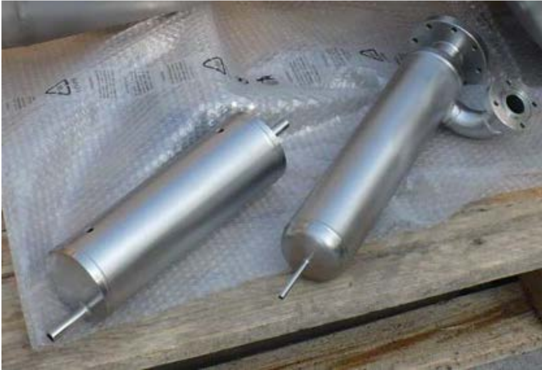
Fig. 14: Accumulo Ammoniaca e Filtro Pompa
