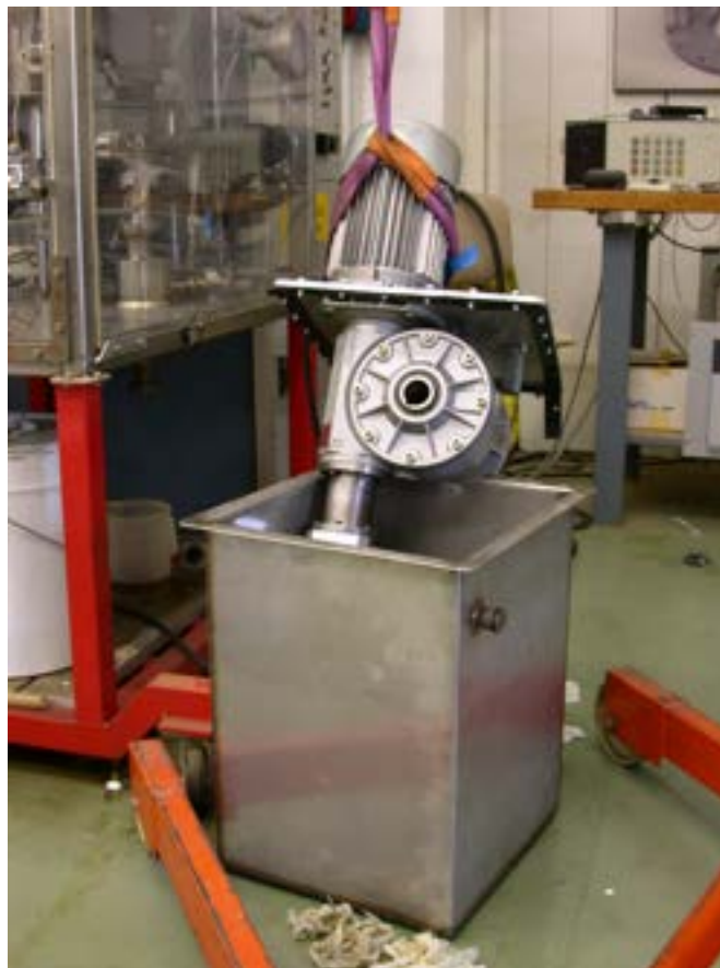
Fig. 12: Pompa della soluzione ricca, fase di montaggio
