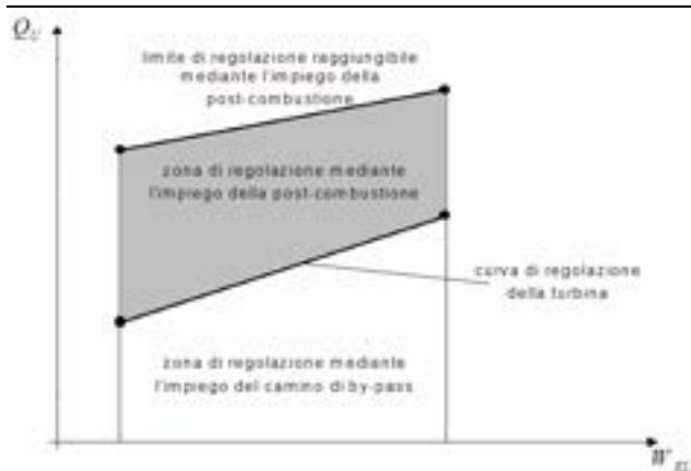
Fig. 3.2.6 - Piano di funzionamento caratteristico di una turbina a gas a ciclo semplice con cammino di by-pass e sistema di post-combustione
