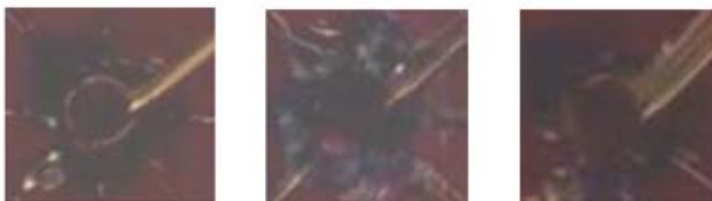
Figura 25 Esempi di rottura di un led dovuti a sovraccarico elettrico (tensione ai capi del led che supera i 5V o eccessivo valore di corrente, rispetto a quello massimo indicato nel data sheets). Altri tipi di rottura si possono avere per shock termico a causa dei diversi valori di dilatazione termica dei materiali che costituiscono il dispositivo 25 .
