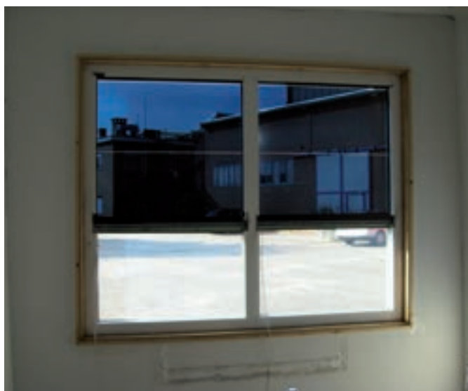
Vetro elettrocromico installato in una cella di prova
