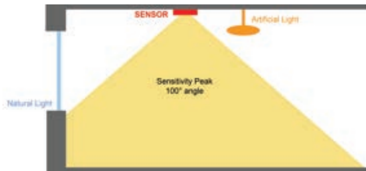
Fig. 16 - Esempio di installazione di un sistema di controllo di daylighting a loop chiuso.
