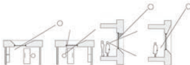
Schemi che illustrano l'efficacia dei lati inclinati delle finestre.
