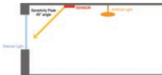
Fig. 1: Esempio di installazione di un sistema di controllo di daylighting a loop aperto.
