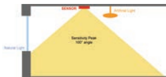
Fig. 2: Esempio di installazione di un sistema di controllo di daylighting a loop chiuso.
