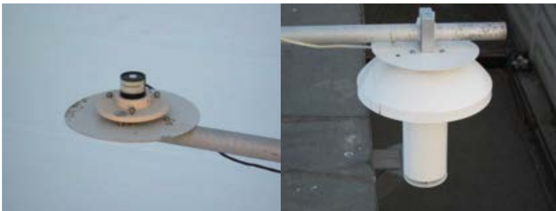
Figura 7: Piranometro e sonda a campana
