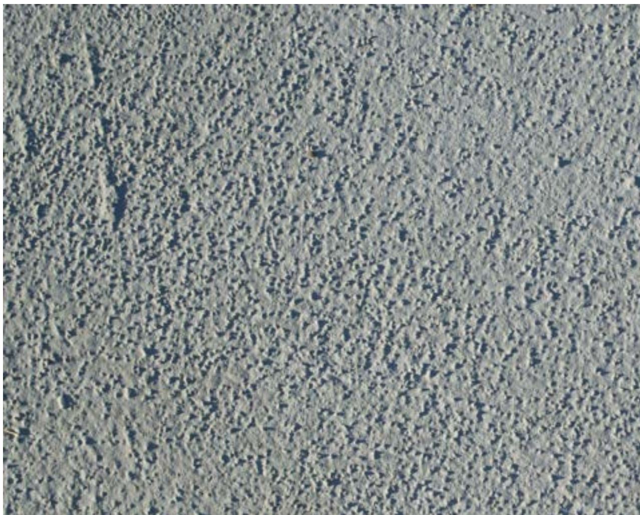
Figura 11 Sito sperimentale: particolare dell'asfalto trattato con rivestimento in biossido di titanio bianco.
