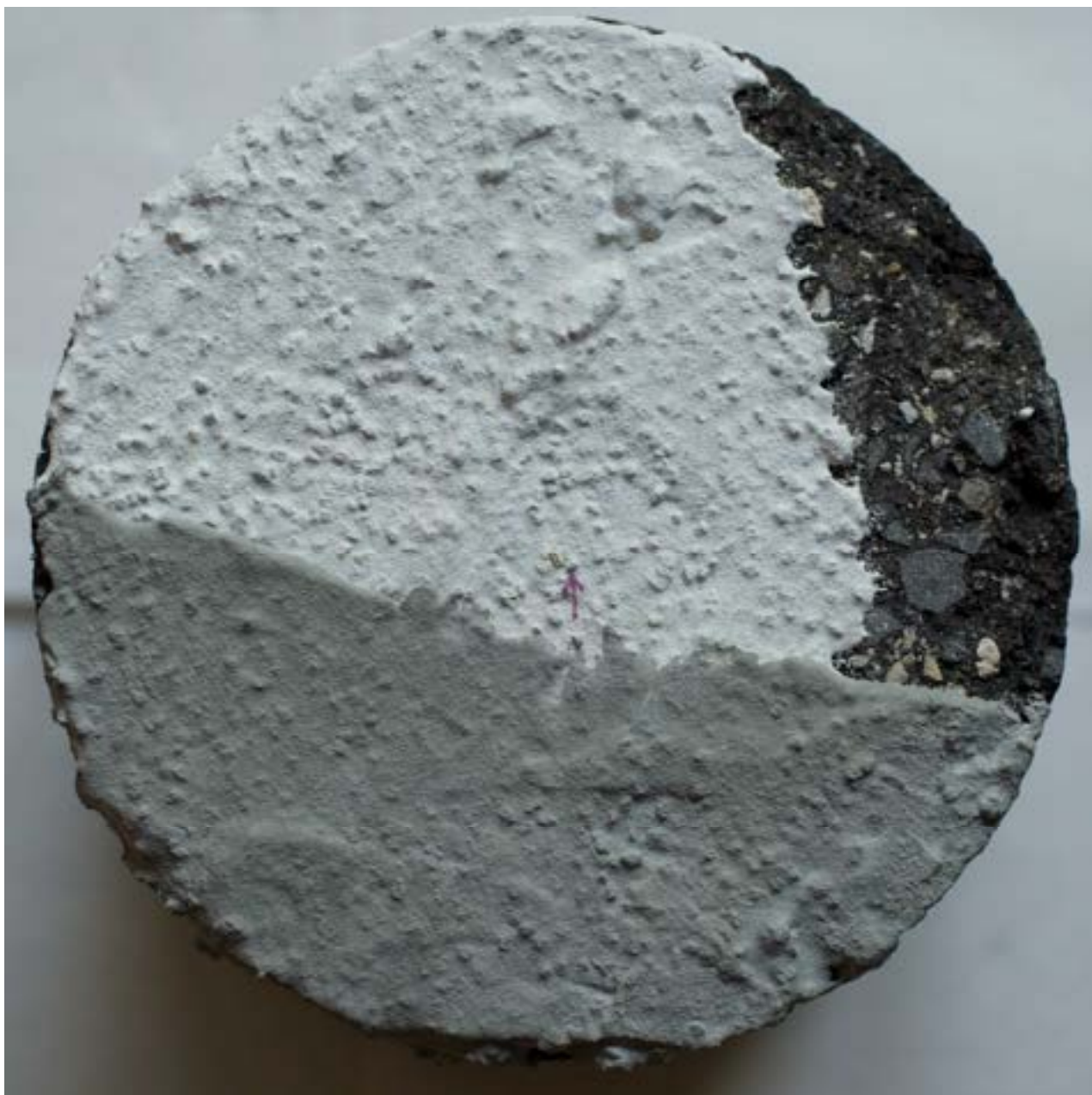
Figura 7 Carota numero 2 con asfalto originale (sample_2_road), asfalto originale, asfalto con rivestimento in biossido di titanio grigio (sample_3_grey), asfalto con rivestimento in biossido di titanio bianco (sample_3_white).
