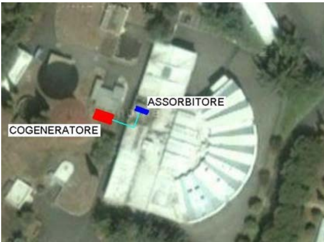
Figura 11 : Posizionamento dell'impianto di trigenerazione presso l'edificio F13
