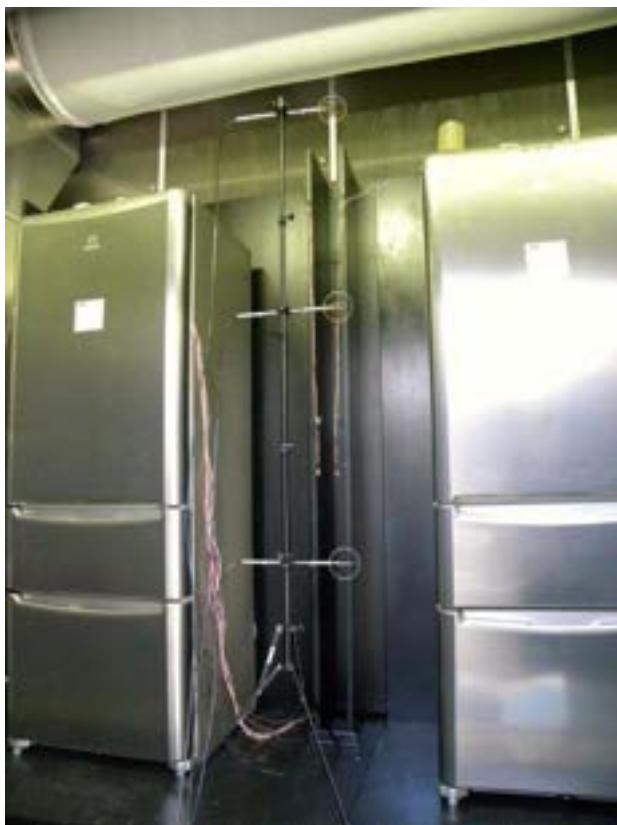
Figura 5: Misura della velocità dell'aria (anemometro) e temperatura nella camera climatica
