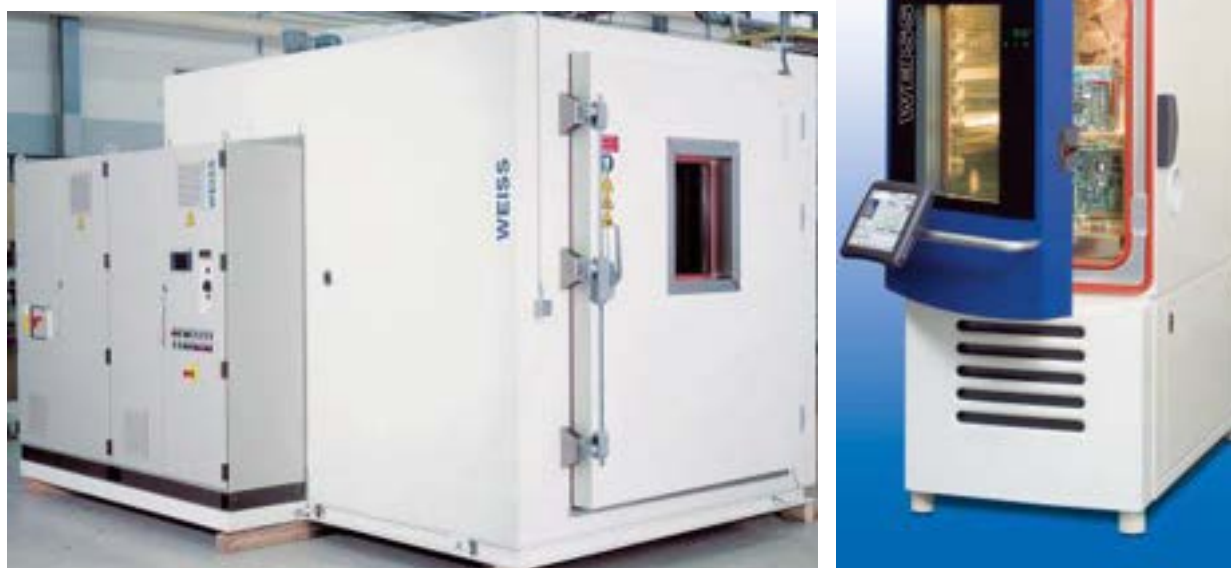
Figura 3: A sinistra: esempio di camera climatica walk-in . A destra: la camera climatica a dimensioni ridotte.
