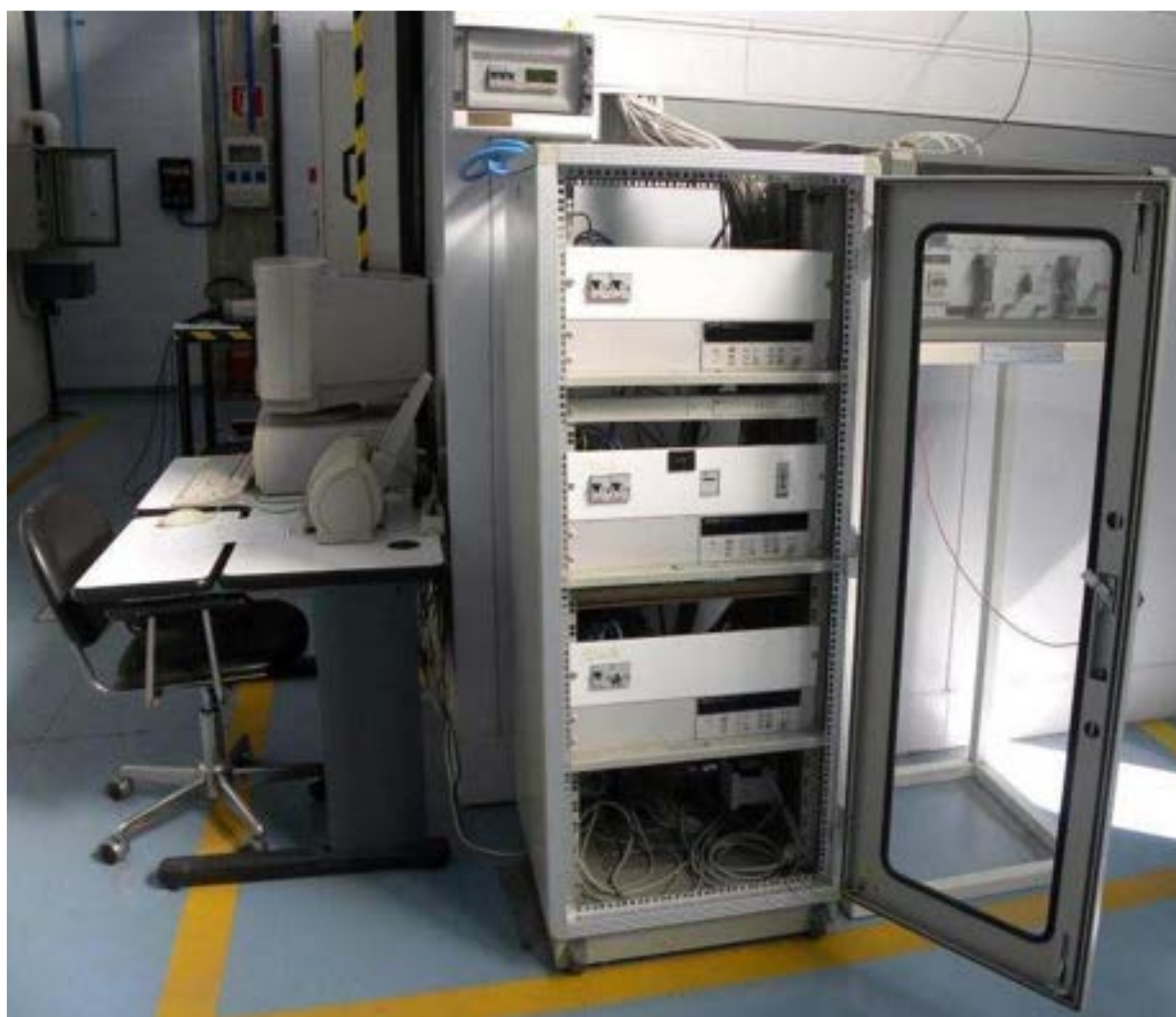
Figura 11: Particolari del sistema di acquisizione dati. In alto a sinistra: calibratore e multimetro per taratura. In alto a destra: acquisitore. In basso: il sistema di acquisizione completo della camera climatica.
