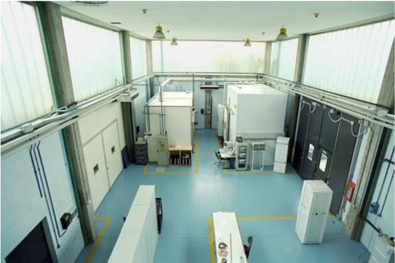
Figura 2: Laboratorio di prove visto dall'alto con le due camere climatiche CC1 e CC2
