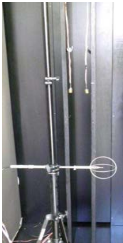
Figura 5: Misura della velocità dell'aria (anemometro) e temperatura nella camera climatica
