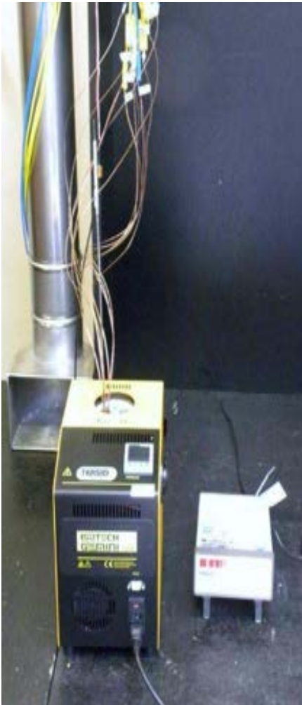
Figura 9: calibrazione di termoresistenze e termocoppie. Sinistra: forno termostatico. Destra: bagno termostatico.
