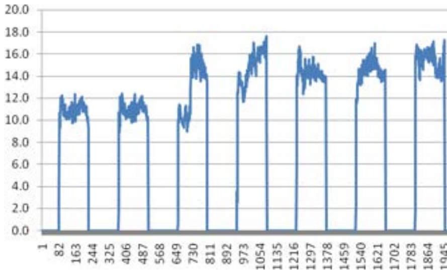
Figura 14: Esempio di output: Potenza frigorifera dell'unità di trattamento aria desiccant cooling nella configurazione D per una tipica settimana estiva – dati sito Palermo
