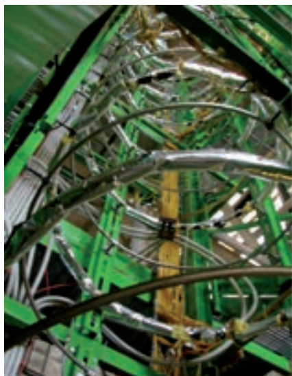
Impianto sperimentale per la caratterizzazione termofluidodinamica dei tubi elicoidali di generatori di vapore
