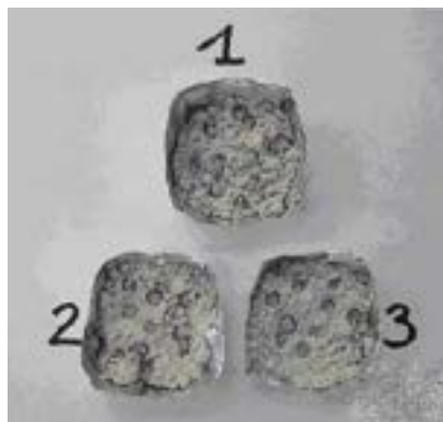
Figura 54. Campioni di scorie umidificati prima della prova di carbonatazione
