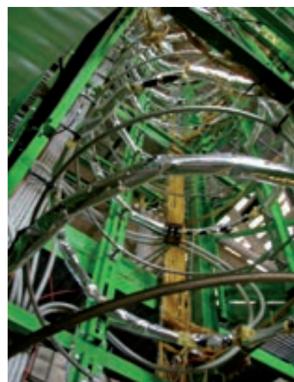
Impianto sperimentale presso SIET per la caratterizzazione termofluidodinamica dei tubi elicoidali dei generatori di vapore di IRIS
