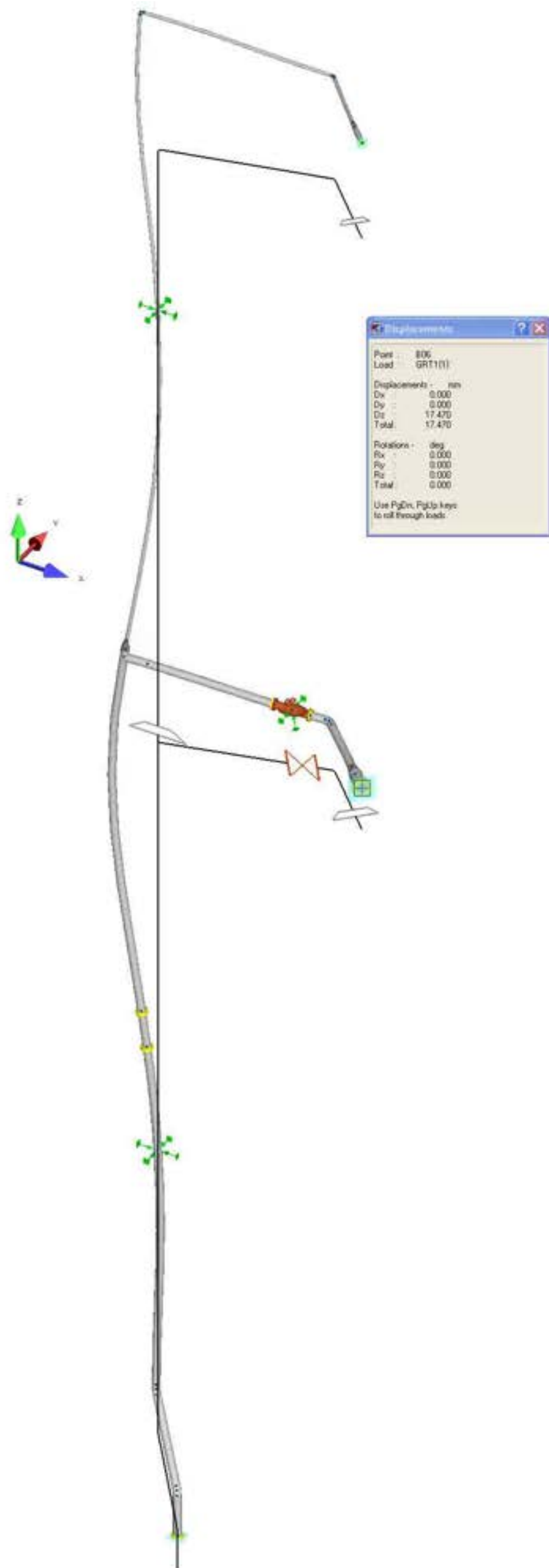
Figura A1-120: DW to PSS-A caso 1: Visualizzazione degli spostamenti del circuito sotto effetto combinato del peso del sistema e del suo contenuto
