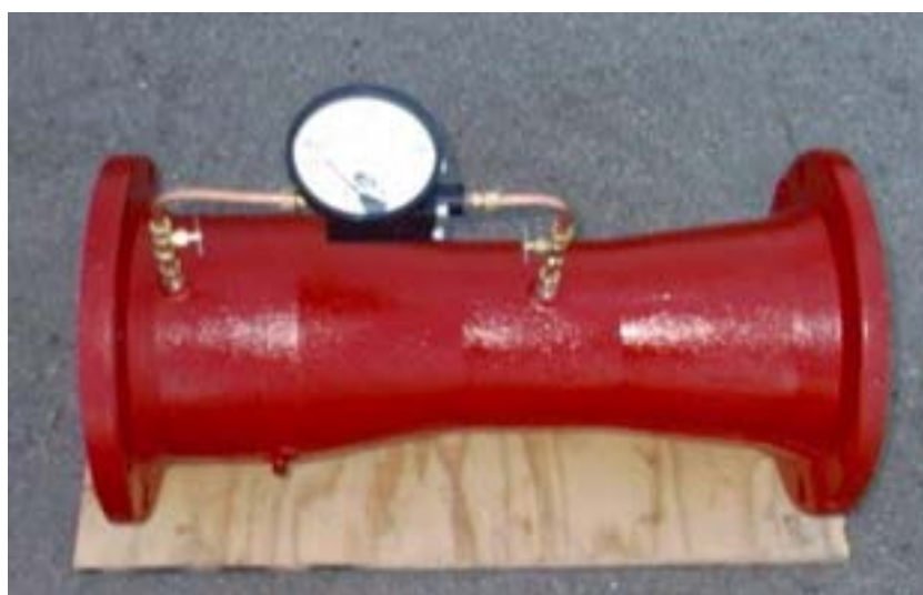
Figura 6: Venturimetro con manometro analogico
