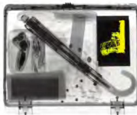
Esempio di segnalazione automatica di masse metalliche ad alto assorbimento (con soglia tarabile)
