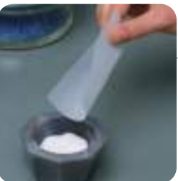
■ Pour flux melting agent into mortar
