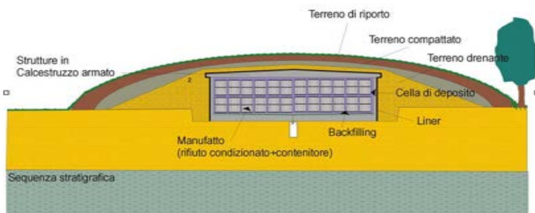
Figura 6.2 – Configurazione finale dell'impianto
