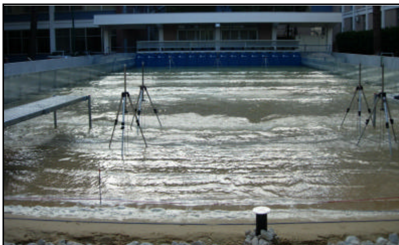
Fig. 3.6 – Modello in vasca 3D per la valutazione dell'evoluzione del litorale
