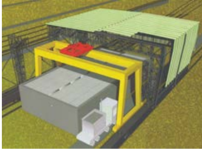
Figura 5: Unità di copertura mobile delle celle.
