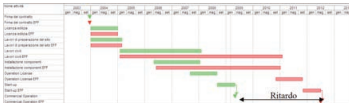
Confronto tra schedula prevista (in verde) e reale (in rosso) per la centrale OL3
