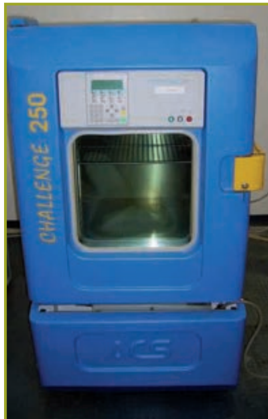
Resistenza a cicli termici Camera climatica Angelantoni Challenge CH 250 C
