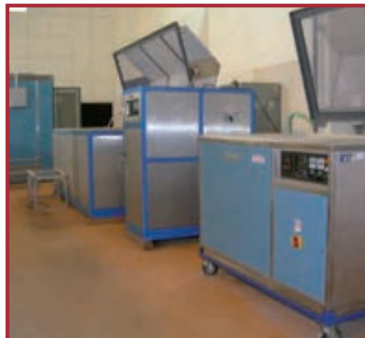
Camere climatiche e camere a nebbia salina per qualifica ambientale di componenti e sistemi nucleari
