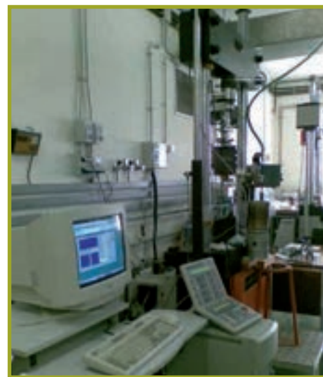
Macchina elettromeccanica Instron 8862 con sistema di gestione remota/acquisizione dati, uno dei componenti del dispositivo prototipo per prove meccaniche in nitrati fusi
