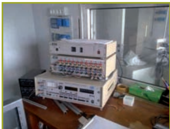
Sistema di taratura strumenti per la misura di temperature
