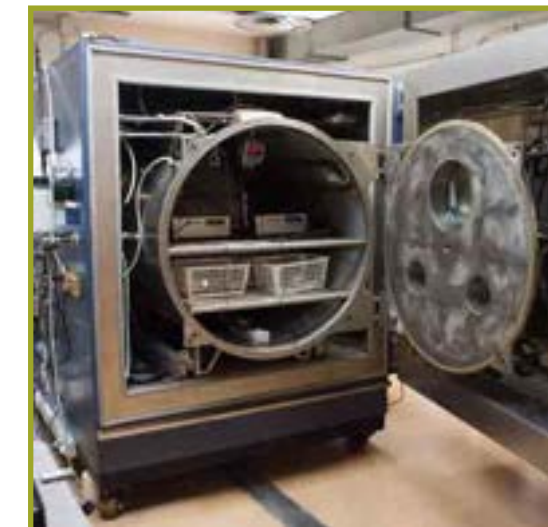
Impianto d'irraggiamento per la dosimetria in atmosfere di riferimento di radon
