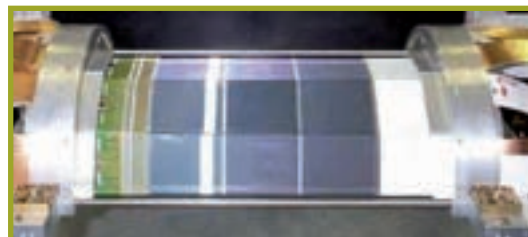
Silicon Microstrip Vertex Detector dell'esperimento di fisica nucleare FINUDA. Il laboratorio ha curato la realizzazione di un sistema di sensori FBG integrato, finalizzato al monitoraggio in tempo reale delle deformazioni strutturali del supporto posizionato in presenza di alti flussi di radiazioni ionizzate e in alto campo magnetico
