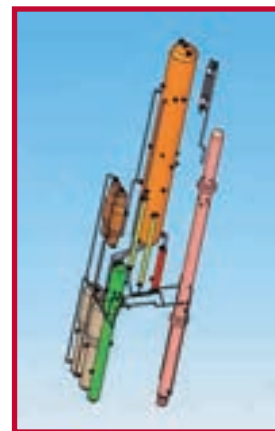
Impianto sperimentale SPES-2: testata superiore del canale di potenza (potenza: 5 MW, n. 97 barre riscaldate)
