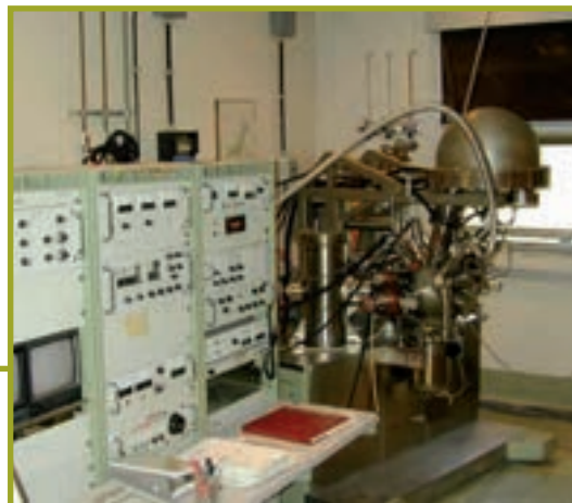
Spettrometro XPS modello VG ESCALAB MK II dotato di doppio anodo, cannone ionico per depth-profiling, lampada UV per analisi UPS, raffreddamento nominale alla temperatura dell’azoto liquido e riscaldamento del campione sino a 800 °C in situ
