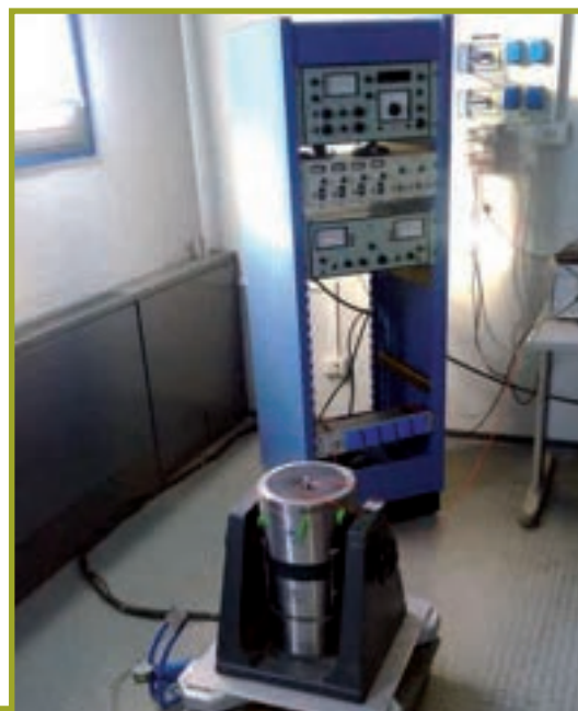
Sistema tradizionale per la taratura di accelerometri (frequenze 10 ÷ 10.000 Hz)
