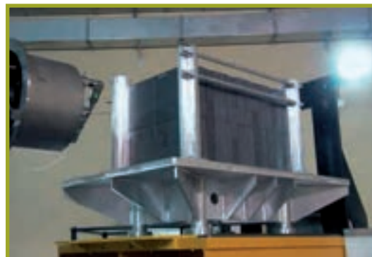
Un blocco di Carburo di Silicio in posizione per l'irraggiamento
