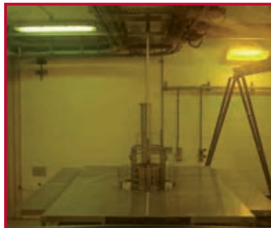
Vista della cella di irraggiamento e della rastrelliera contenente le sorgenti di ^{60}\text{Co} ; in primo piano la piattaforma per il posizionamento dei campioni
