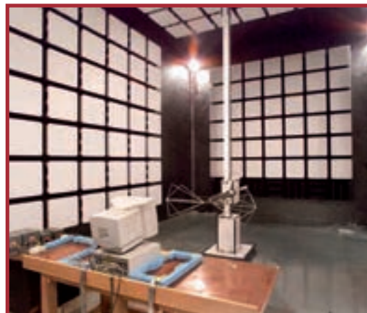
Vista interna della camera semianecoica "Vecuvia"
