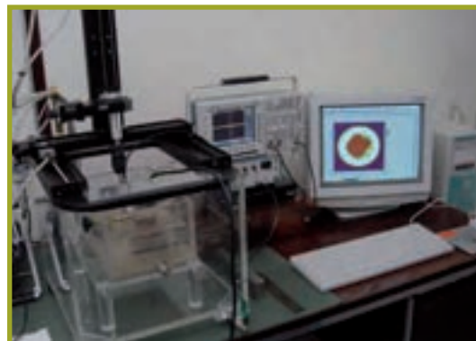
Sistema automatico general purpose con sonde ad ultrasuoni ed Eddy current con 4 gradi di libertà
