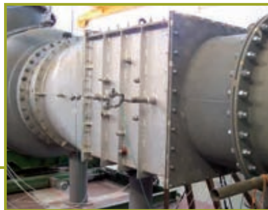
Sezione di prova "combustione esterna" (dimensione sezione di passaggio fumi 600x600 mm)
