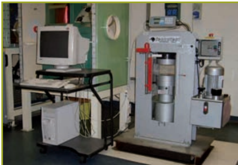
Resistenza a compressione Pressa Tecnotest KC 150
