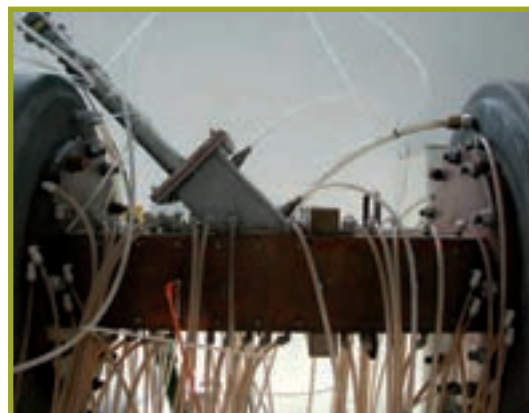
Sezione di prova "turbogas" (dimensione sezione di passaggio fumi 90x280 mm)
