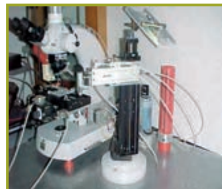
Sistema automatico di alimentazione e lettura al microscopio ottico dei rivelatori di CR-39
