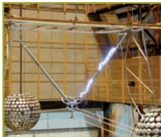
Prova dielettrica su isolatori compositi con difetti
