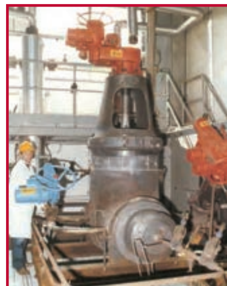
Prove di crisi termica su fascio di barre reattore BWR (potenza: 10 MW; pressione: 70 bar)
