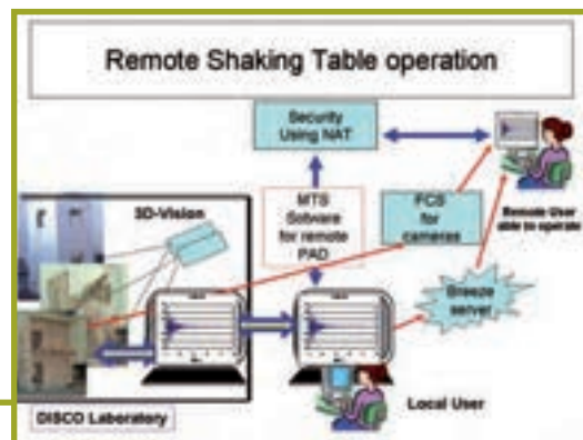
Esempio di condivisione in tempo reale della prova di caratterizzazione dispositivi antisismici innovativi EARLYPROT
