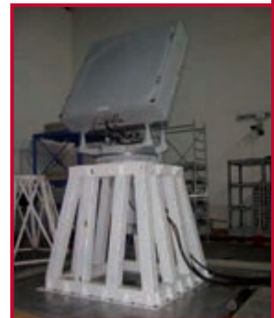
Test dinamico/funzionali su sistema d'antenna radar
