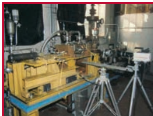
Impianto IETI: prove di scambio ad elevatissimi flussi termici (fino a 37 MW/m 2 )
