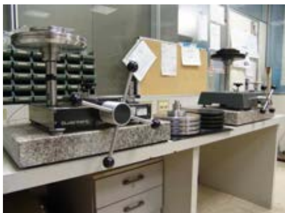
Figura n. 62 - Laboratorio Metrologico SIET Banco Taratura Misuratori di Pressione
