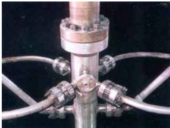
Figura n. 11 - SPES-2: Hot Leg / Cold Leg, connessioni al Canale di Potenza
