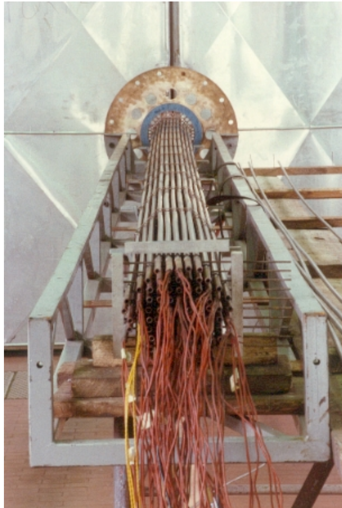
Figura n. 9 - SPES: Fascio di Barre del Canale di Potenza con Termocoppie
