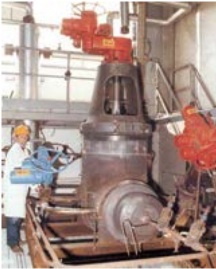
Figura 42 - PROVE DI PRESSURIZZAZIONE CON VAPORE DI VALVOLA A SARACINESCA DA 12"
