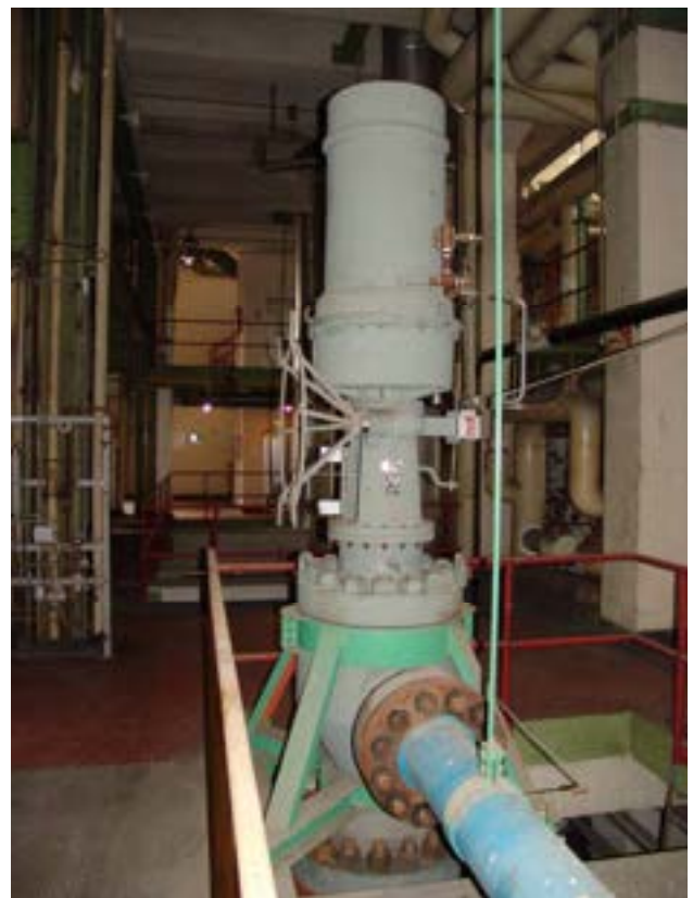
Figura 39 - VALVOLA ALTO LAZIO 8"X20" IN PROVA PRESSO SIET
