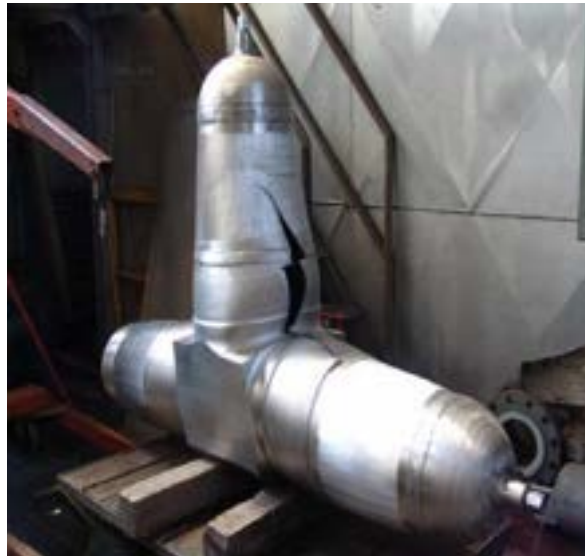
Figura 49 - PROVA DI SCOPPIO RACCORDO 12" PER PWR
