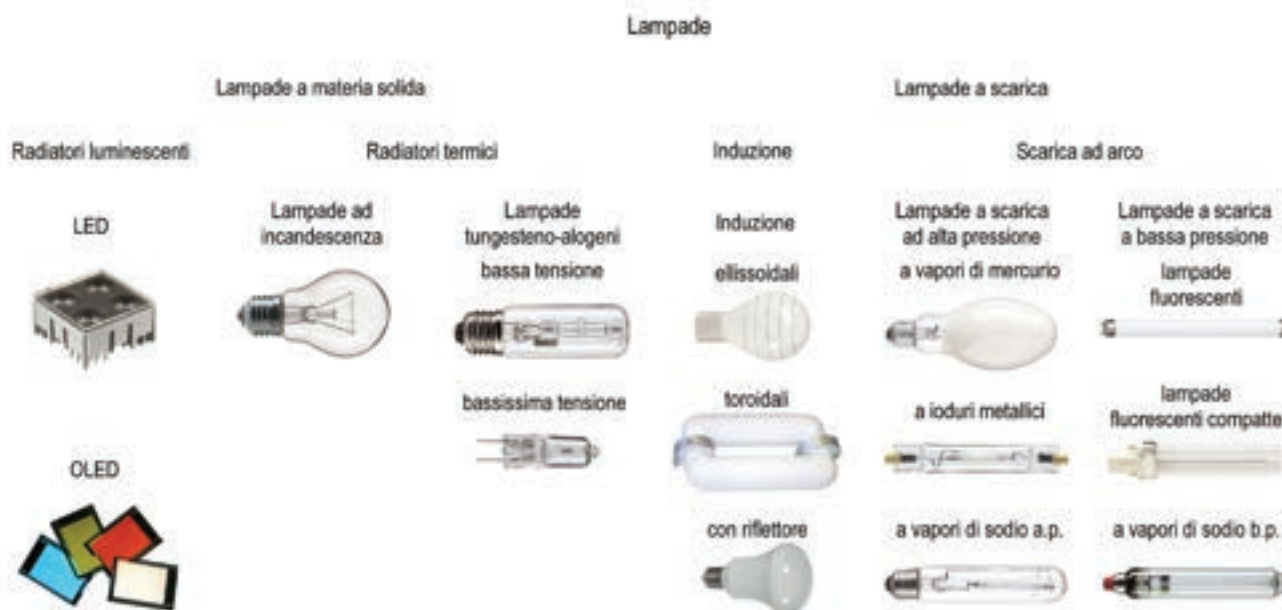
Fig. 7 - Schema delle principali famiglie di sorgenti luminose comunemente usate nell'illuminazione di interni ed esterni.
