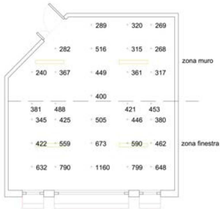
Figura 5.33. 21 Giugno Cielo Sereno ore 12, limite massimo di penetrazione della luce diurna: valori di illuminamento sul piano di lavoro in presenza dei sistemi di daylighting e PSALI
