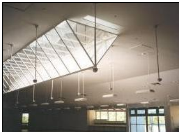
Figura 1.36. Lucernario selettivo angolare all'Erbario, Brisbane, Australia
