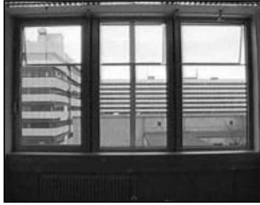
Figura 1.32. Vista interna di una stanza di prova con pannelli laser cut ruotati nel terzo superiore della vetrata.
