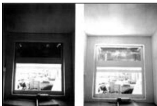
Figura 1.38. Confronto tra la luce del giorno presente in una stanza dotata di una schermatura convenzionale (sinistra) e in una con un light guiding shade (destra).
