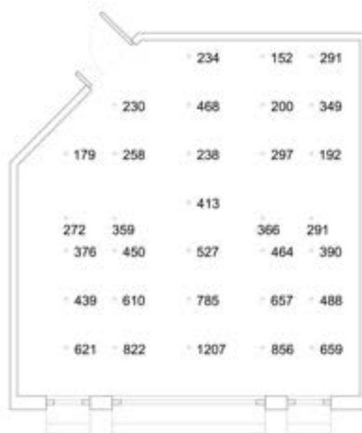
Figura 5.29. 21 Giugno Cielo Sereno ore 12: valori di illuminamento sul piano di lavoro in presenza del sistema di daylighting
