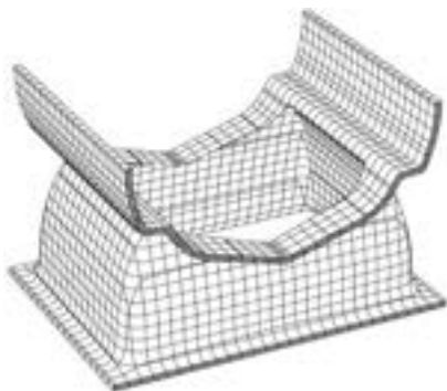
Fig. 71 - Modulo di un'ottica alveolare della piantana Minium Lite prodotto in pezzo unico, quindi stabile e regolare, rivestito di alluminio applicato a vapore. La distribuzione è prevalentemente indiretta (Zumtobel).
