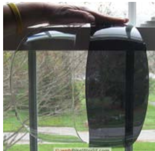
Fig. 23 - Schermo per casco in materiale fotocromico prima e dopo l'esposizione alla luce naturale.
