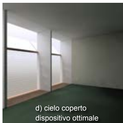
Fig. 14 - Simulazioni della distribuzione della luce in un locale nel caso di cielo coperto o di cielo sereno, con varie tipologie di lightshelves.
