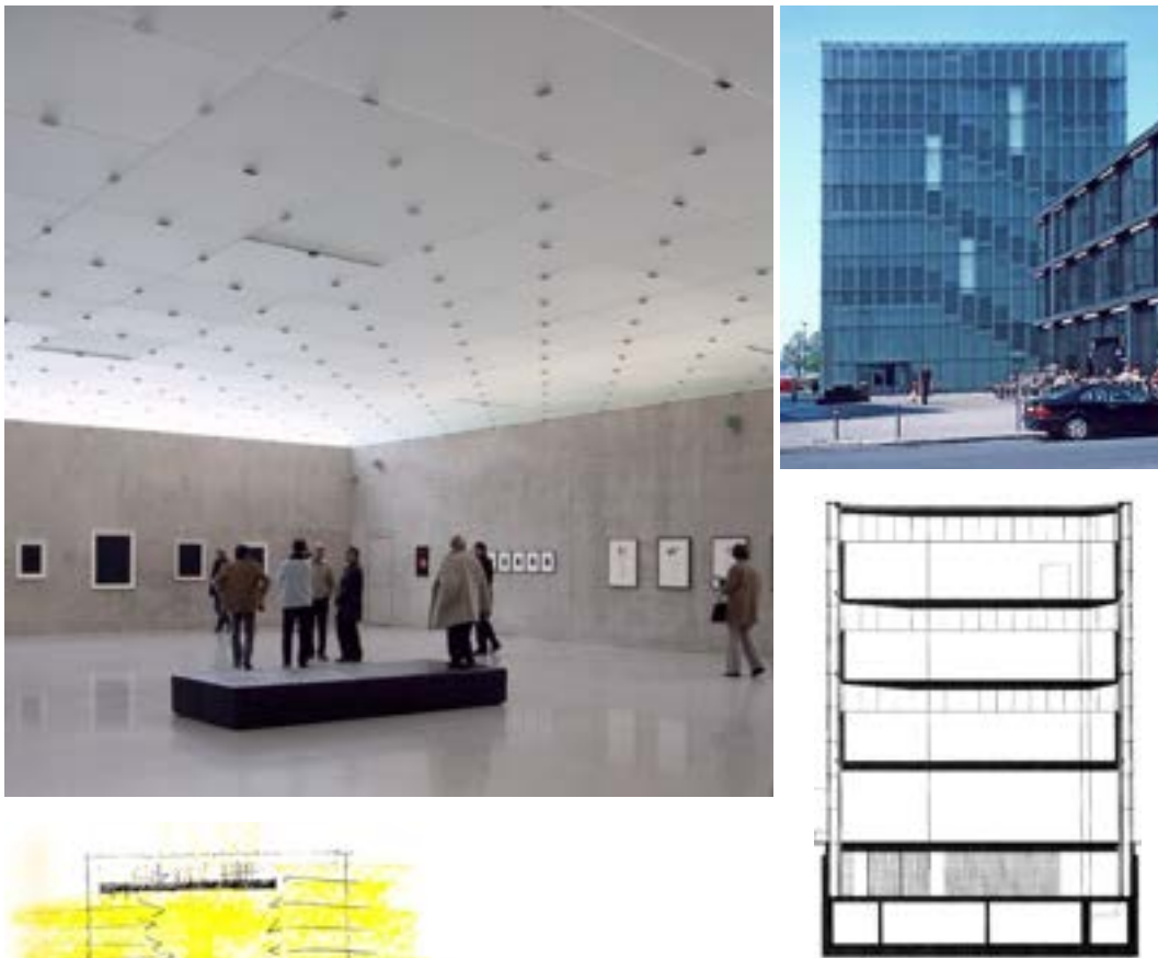
Fig. 123 - Kunsthhaus di Bregenz. Il progetto di Peter Zumthor prevede la creazione di soffitti a luce naturale che nascondono anche i sistemi di illuminazione artificiale la cui luce è completamente integrata a quella diurna.
