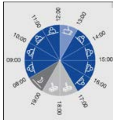
Fig. 85 - Esempio di impostazioni orarie predefinite per l'accensione e lo spegnimento automatico dei punti luce di un ufficio (immagine Zumtobel).
