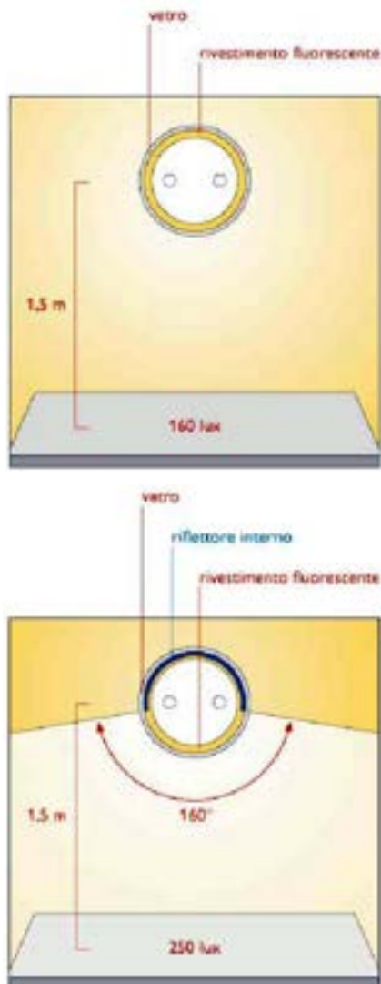
Fig. 47 - Confronto tra l'emissione di un normale tubo fluorescente nudo e di un tubo Philips MASTER TL-D Super 80 Reflex Riciclabile.
