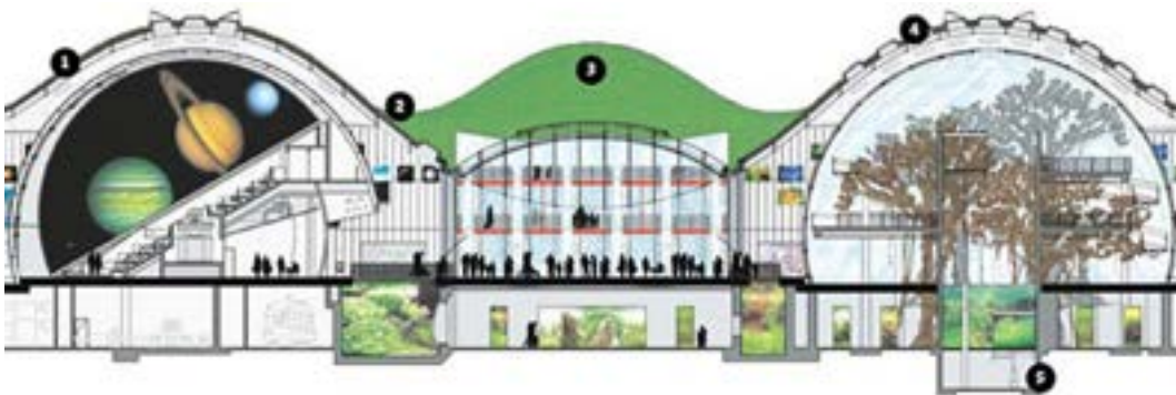
Fig. 125 - Progetto del Museo Maserati a Modena dello Studio Future Systems. L'ingresso della luce naturale nel grande ambiente interno è assicurato dalle feritoie orientate a nord inserite nella copertura. Sarà un complesso museale ad alto risparmio energetico ed elevata sostenibilità ambientale, poiché dotato di sistemi di controllo e dispositivi geotermici e realizzato con materiali e soluzioni impiantistiche all'avanguardia.
