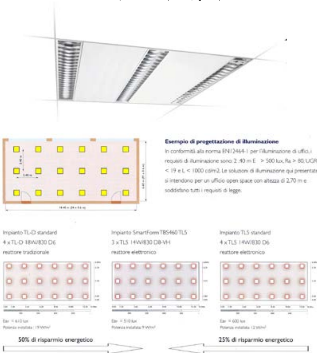
Fig. 35 - Esempi di diverse combinazioni di reattore, lampada e ottica con consumi per unità di superficie molto differenti (Philips).
