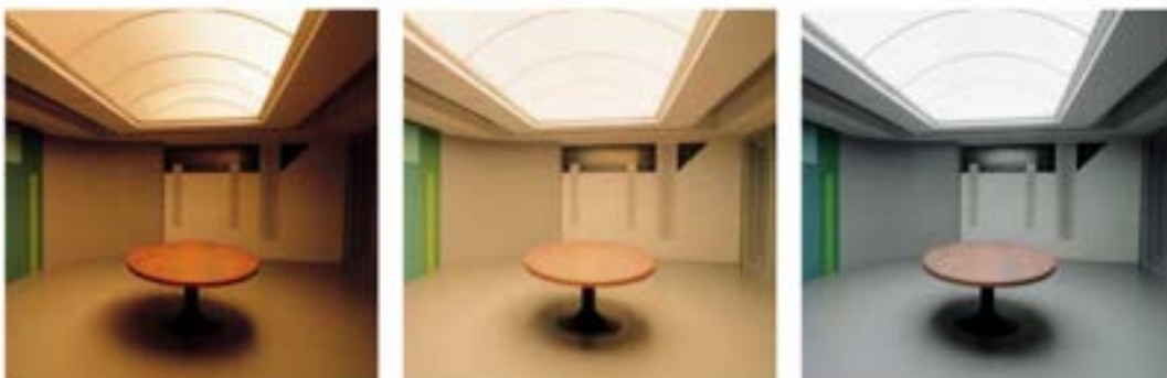
Fig. 83 - Illuminazione "cromodinamica" in un ambiente privo di finestre per simulare le variazioni della luce naturale (iGuzzini).
