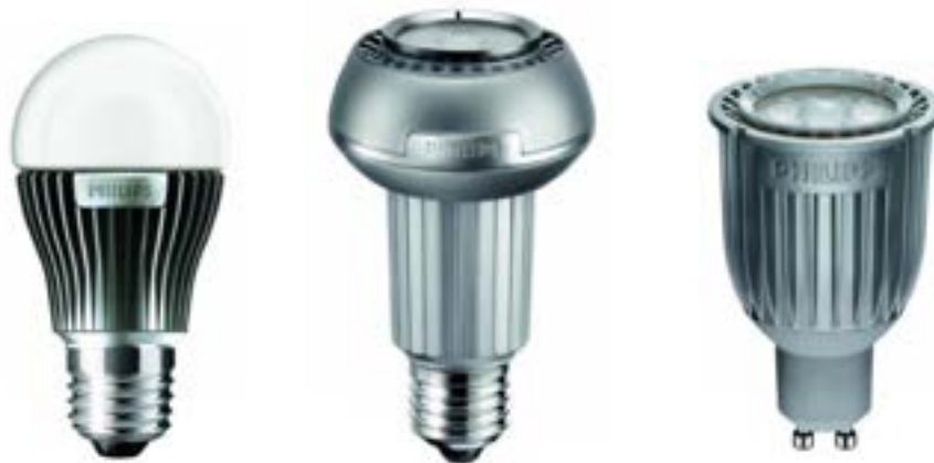
Fig. 60 - Lampade Philips MasterLED da 7W: la prima sostituisce un'incandescenza da 40W, la seconda un'incandescenza con riflettore sempre da 40W e fascio 25° o 40°, la terza una lampada ad alogeni con riflettore dicroico da 35W con fascio da 25° o 40°.
