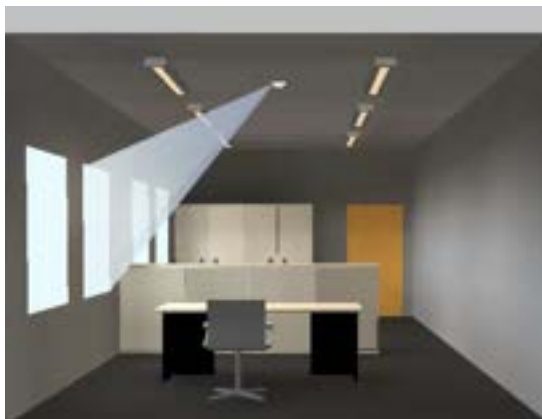
Figura 13 - Fotosensore di tipo open loop interno: misura il flusso luminoso proveniente dal componente finestrato
