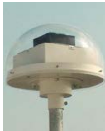
Figura 12 - Fotosensore di tipo open loop (rilevatore esterno di luce diurna): misura il flusso luminoso proveniente dalla volta celeste
