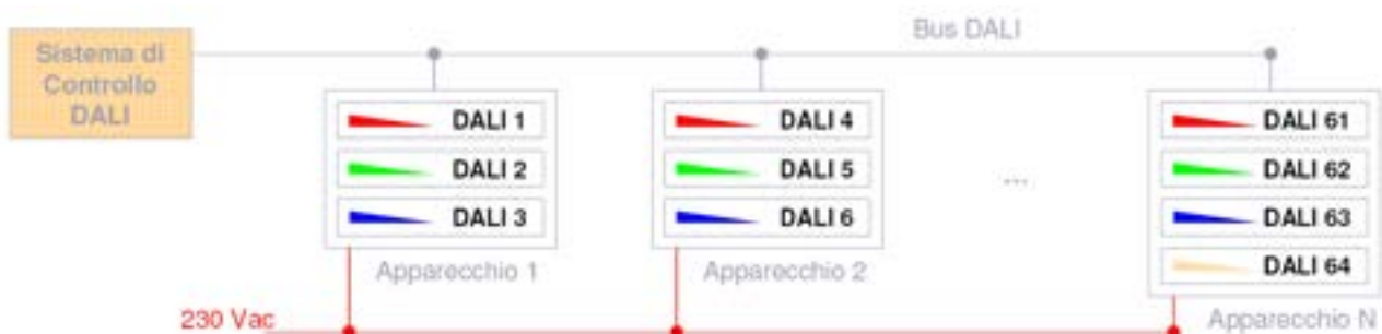
Figura 30 - Schema di funzionamento del protocollo DALI (fonte: PHILIPS)
