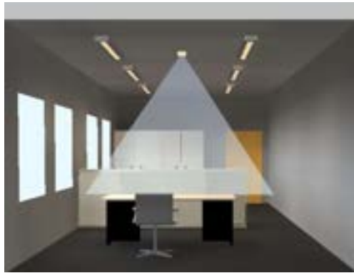
Figura 11 - Fotosensore di tipo closed loop per installazione nel controsoffitto
