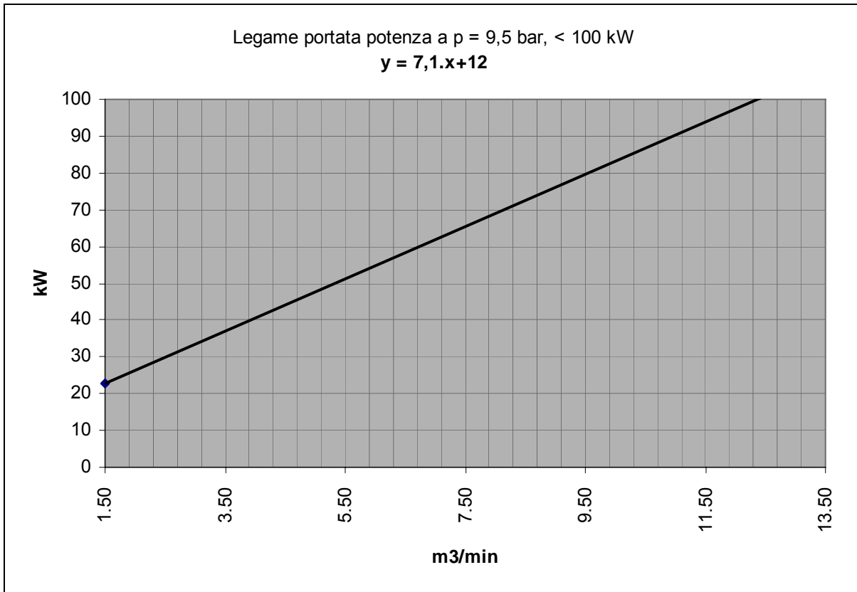
Fig. 5.6 Curva universale che mette in relazioni la portata media erogabile dalla macchina con regolazione di velocità e la potenza media assorbita dalla rete @ 9,5 bar r per potenze fino a 100 kW
