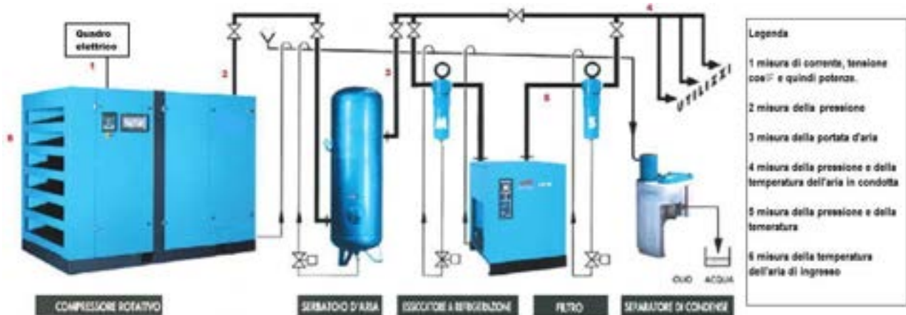
Fig.2.0.1 schema generale di un circuito ad aria compressa con punti di misura riportati sullo schema e in legenda.
