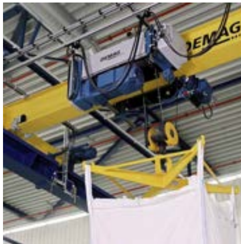
Fig. 1. Vista di insieme del carrello con in evidenza il motore di sollevamento, il motore per lo spostamento del carrello e il motore per l'avanzamento del carriponte
