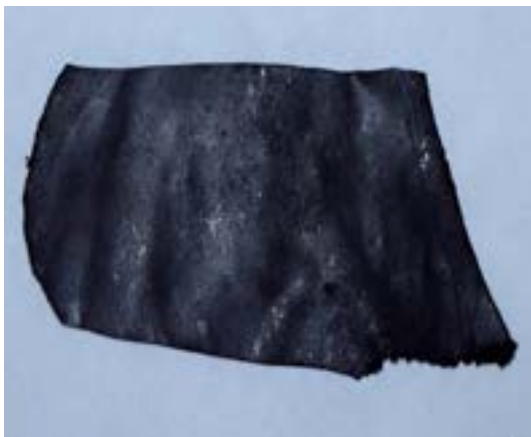
Nastro anodico composito TiO_2 -carbone-PTFE ottenuto dall'ENEA dopo calandatura
