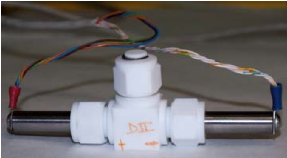
Figura 2. Tipologia di cella a "T" realizzata in Teflon.
