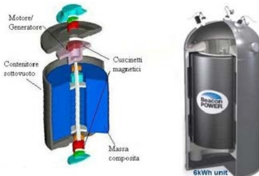
Fig. III.3 - Schema di un volano da 6 kWh prodotto dalla Beacon Power
